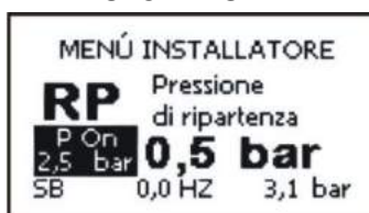
Obrázok 16: Nastavenie tlaku na účely opätovného spustenia
