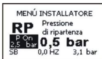
Figura 16: Impostazione della pressione di ripartenza
