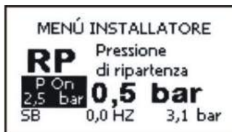
Figure 16: Configuration de la pression de redémarrage
