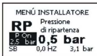
Abbildung 16: Einstellung des Neustartdrucks
