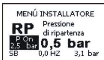
Afbeelding 16: Instelling van de druk voor herstart
