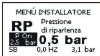
Figura 16: Configuração da pressão de novo arranque
