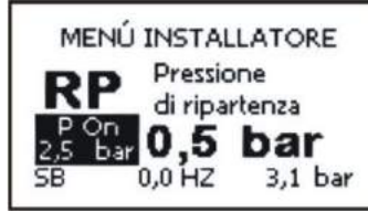
Şekil 16: Yeniden başlatma basıncının ayarlanması
