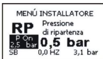
Rysunek 16: Ustawianie wartości ciśnienia uruchamiania
