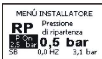
Σχήμα 16: Ρύθμιση της πίεσης επανεκκίνησης
