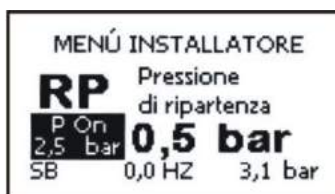
Figura 16: Configuración de la presión por re arranque
