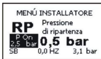
Малюнок 16: Налаштування тиску нового увімкнення
