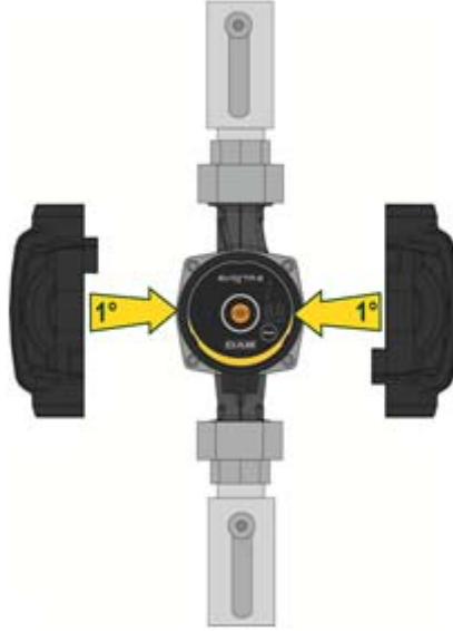
Resim 7: Pompa gövdesinin yalıtımı
