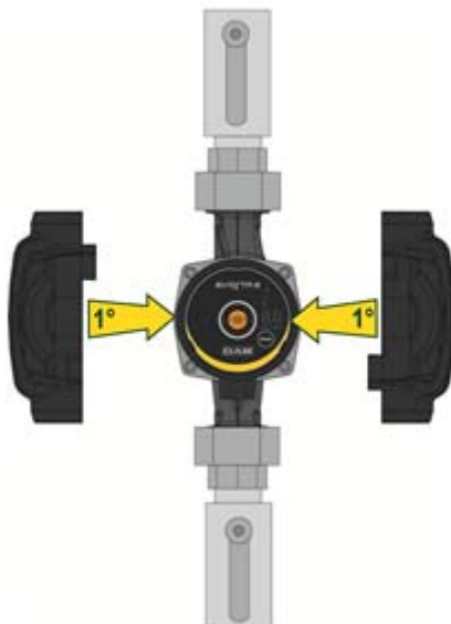
Figura 7: Izolare corp pompa
