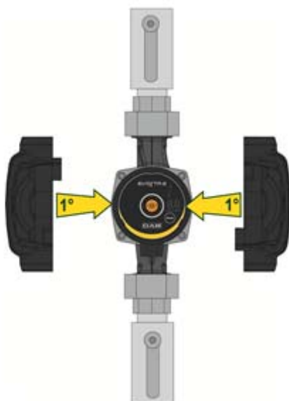
7. ábra: A pumpatest elszigetelése
