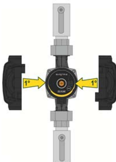
Figura 7: Isolamento do corpo da bomba
