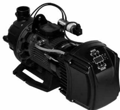
**DATI TECNICI****Campo di funzionamento:** da 3 a 45 m<sup>3</sup>/h**Prevalenza massima:** 24 m**Massima pressione d'esercizio:** 6.5 bar**Campo di temperatura del liquido:** da -10 a +55°C**Massima percentuale di glicole:** fino al 40%**Installazione:** fissa o portatile in posizione orizzontale**Liquido pompato:** pulito, libero da sostanze solide o abrasive chimicamente neutro, prossimo alle caratteristiche dell'acqua**Max temperatura ambiente:** 40 °C**Versioni speciali a richiesta:**
