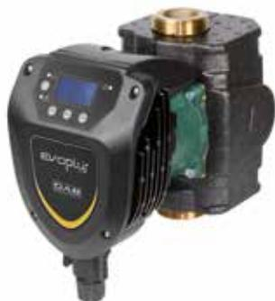
Circulateur pour les installations d'eau chaude sanitaire à circuit fermé sous pression ou à circuit ouvert. Corps de pompe en bronze. Caisse moteur en aluminium moulé. Roue en technopolymère. Axe moteur en céramique avec roulements en graphite lubrifiés par le liquide pompé. Manchons du rotor et du stator et bride de fermeture en acier inoxydable. Bague de butée en céramique, bagues d'étanchéité en éthylène-propylène. Moteur synchrone avec rotor à aimants permanents.
