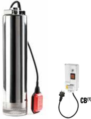
Pompes monobloc submersibles multicellulaires 5". Conçues pour la pressurisation, le jardinage, l'irrigation et le lavage d'eau dans les bâtiments résidentiels. Elles fonctionnent immergées dans les puits et les premières cuves de récolte d'eau ou les citernes. Le moteur est situé au-dessus de la partie hydraulique et est refroidi par le liquide pompé.
