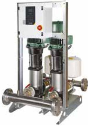
1-2-3-4 NKVE MCE sont des unités de pressurisation à **vitesse variable** avec 1, 2, 3 ou 4 pompes centrifuges multicellulaires à axe vertical NKV en acier inoxydable, pour des systèmes d'eau d'utilisateurs de moyennes et grandes dimensions. L'utilisation d'électropompes centrifuges multicellulaires à axe vertical assure des performances élevées. **Toutes les parties en contact avec le liquide sont antirouille.**
