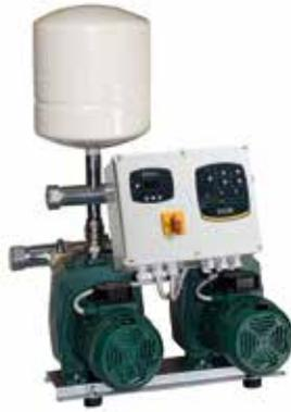
2 Jet de DAB est un groupe de pression comprenant 2 pompes auto-amorçantes Jet et un coffret électrique EBox Plus (avec écran) installé de série, conçu pour la pressurisation et la collecte dans le sous-sol dans des applications domestiques, résidentielles, civiles et commerciales.
