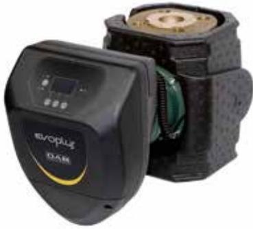
Circulateur pour les installations d'eau chaude sanitaire à circuit fermé sous pression ou à circuit ouvert. Corps de pompe en bronze. Caisse moteur en aluminium moulé. Roue en technopolymère. Axe moteur en acier avec roulements en céramique lubrifiés par le liquide pompé. Manchons du rotor et du stator et bride de fermeture en composite à base de fibre de carbone. Bague de butée en céramique, bagues d'étanchéité en éthylène-propylène. Moteur synchrone avec rotor à aimants permanents.
