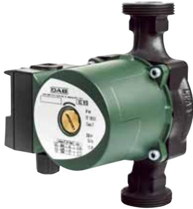
Corps unique constitué d'une unité hydraulique en fonte. Carter du moteur en aluminium moulé sous pression. Roue en technopolymère. Axe moteur en aluminium avec roulements en graphite lubrifiés par le liquide pompé. Manchons du rotor et du stator et bride de fermeture en acier inoxydable. Bague de butée en céramique, E.P.D.M. Joints toriques et bouchon de refoulement d'air en laiton. Le moteur à deux pôles, de type asynchrone, avec rotor noyé, n'a pas besoin de protection pour la résistance.
