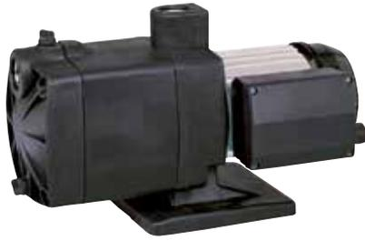
Pompe de surface multicellulaire auto-amorçante conçue spécialement pour pomper de l'eau salée. Performances silencieuses et à haute pression. **Disponible avec 4 roues Noryl.** Matériaux résistants à la corrosion et à la rouille. Moteur avec protection thermique contre la surcharge. Double système d'étanchéité entre le moteur et la partie hydraulique. Résistance élevée au gel. Fournie avec câble d'alimentation avec fiche et raccord auto-étanche. Fournie avec câble d'alimentation et fiche.
