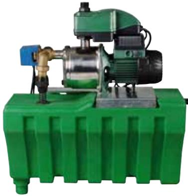
Active Switch est un système complet et pré-assemblé pour utiliser l'eau de pluie dans une maison pour une ou deux familles. Le système est doté d'une cuve en polyéthylène recyclable, une pompe automatique Active EI 30/50 M série et une vanne automatique à 3 voies montée sur le port d'aspiration de la pompe. Le système a été conçu pour un montage mural. Fourni avec support mural et flotteur, 20 m de câble, de série
