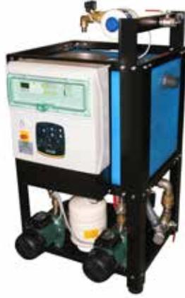
Groupe de pressurisation pour la gestion des systèmes et la réutilisation d'eau de pluie avec 2 pompes centrifuges type EUROINOX ou JETINOX. Fourni avec cuve de réserve d'eau jusqu'à 150 l intégrée dans le système. Pour les systèmes moyens à grands.
