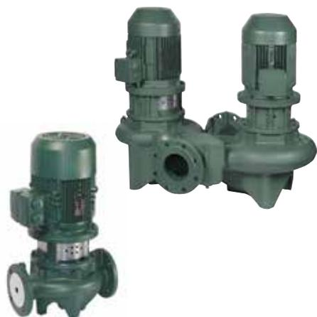
Pompes de circulation avec orifices en ligne, adaptées aux installations civiles et industrielles de chauffage, climatisation et eau chaude sanitaire. Corps pompe et support moteur en fonte. Orifices d'aspiration et de refoulement avec bride PN 16, munis de trous filetés pour manomètres de contrôle. Roue en technopolymère, garniture mécanique en carbone/céramique.
