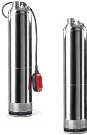
Pompe submersible monobloc multicellulaire 5" conçue pour la pressurisation, le jardinage, l'irrigation et le lavage d'eau dans les bâtiments résidentiels. Ces pompes fonctionnent immergées dans les puits et les premières cuves de récolte d'eau et les citernes. L'aspiration est effectuée à travers un filtre situé dans la partie inférieure de la pompe.
