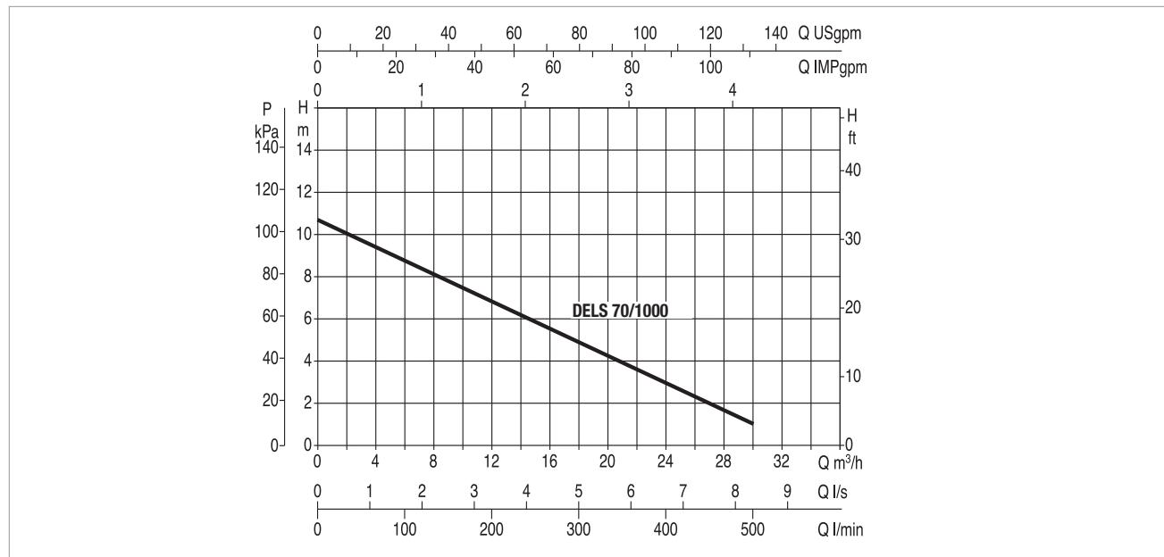
Le curve delle prestazioni si basano su valori di viscosità cinematica = 1 mm<sup>2</sup>/s e densità pari a 1000 kg/m<sup>3</sup>.
