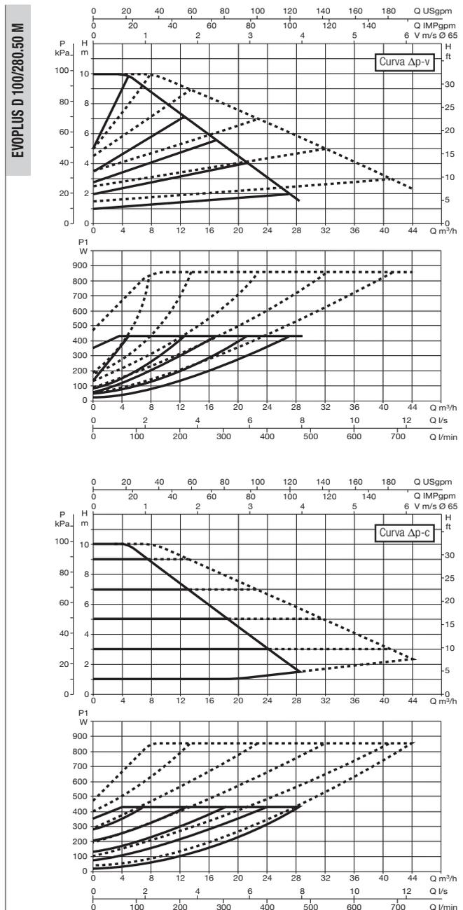
Le curve sono basate su valori di viscosità cinematica = 1 mm<sup>2</sup>/s e densità pari a 1000 kg/m<sup>3</sup>. Tolleranza delle curve secondo ISO9906. Curve a velocità fissa disponibili sul DNA.
