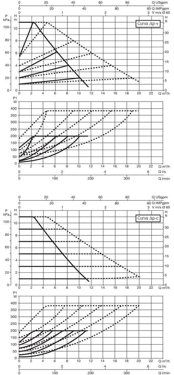
Le curve sono basate su valori di viscosità cinematica = 1 mm<sup>2</sup>/s e densità pari a 1000 kg/m<sup>3</sup>. Tolleranza delle curve secondo ISO9906. Curve a velocità fissa disponibili sul DNA.
