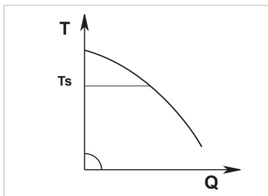
La modalità di regolazione  $\Delta T$ -c **mantiene costante la temperatura differenziale del liquido pompato, variando la portata al valore impostabile Tsetp.**
