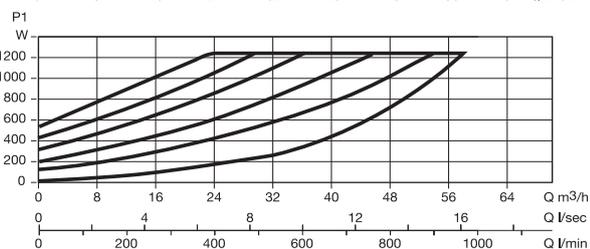
Le curve sono basate su valori di viscosità cinematica = 1 mm<sup>2</sup>/s e densità pari a 1000 kg/m<sup>3</sup>. Tolleranza delle curve secondo ISO9906. Curve a velocità fissa disponibili sul DNA.
