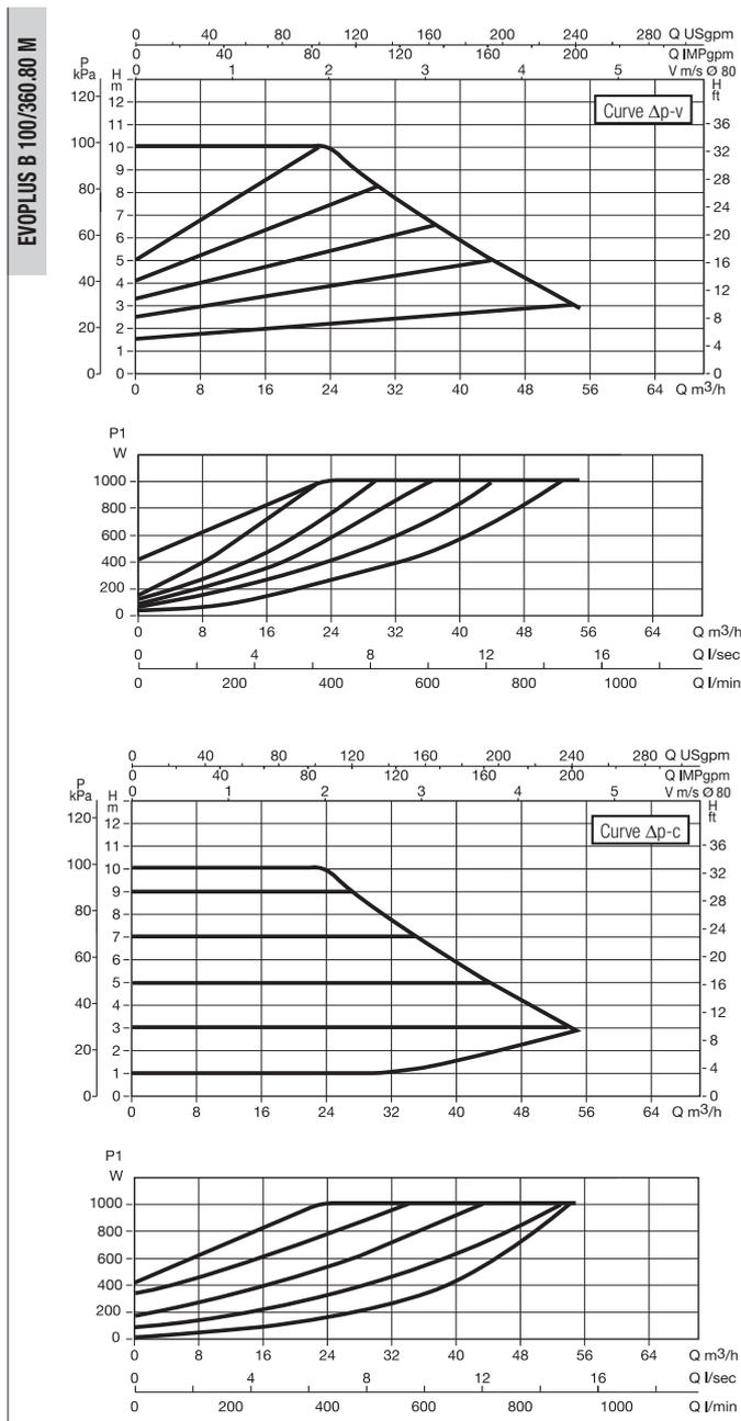
Le curve sono basate su valori di viscosità cinematica = 1 mm<sup>2</sup>/s e densità pari a 1000 kg/m<sup>3</sup>. Tolleranza delle curve secondo ISO9906. Curve a velocità fissa disponibili sul DNA.
