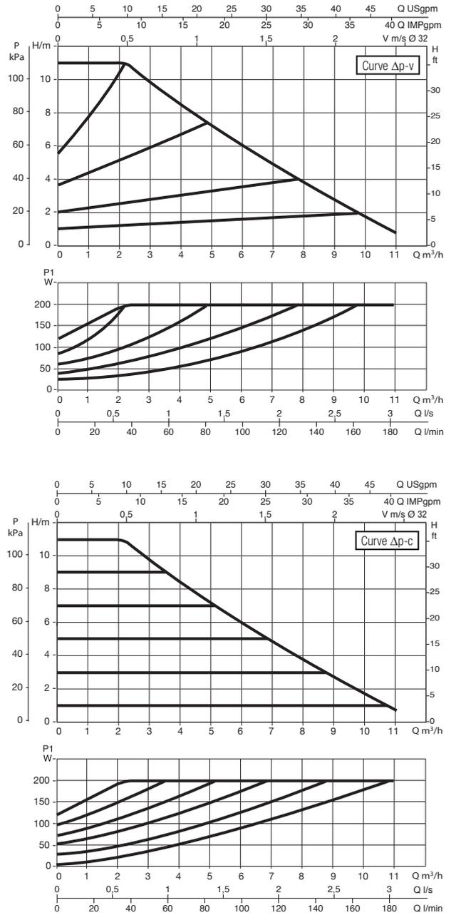
Le curve sono basate su valori di viscosità cinematica = 1 mm²/s e densità pari a 1000 kg/m³. Tolleranza delle curve secondo ISO9906. Curve a velocità fissa disponibili sul DNA.
