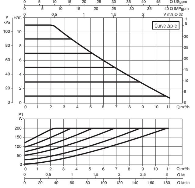
Le curve sono basate su valori di viscosità cinematica = 1 mm²/s e densità pari a 1000 kg/m³. Tolleranza delle curve secondo ISO9906. Curve a velocità fissa disponibili sul DNA.
