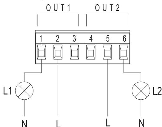
La luce L1 si accende quando nel sistema è presente un allarme e si spegne quando non si riscontra alcun tipo di anomalia, mentre la luce L2 si accende quando la pompa è in marcia e si spegne quando la pompa è ferma.
