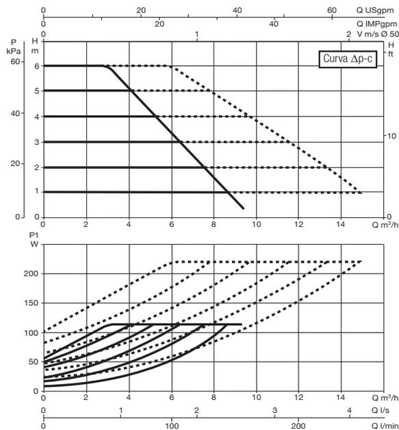
Le curve sono basate su valori di viscosità cinematica = 1 mm²/s e densità pari a 1000 kg/m³. Tolleranza delle curve secondo ISO9906. Curve a velocità fissa disponibili sul DNA.
