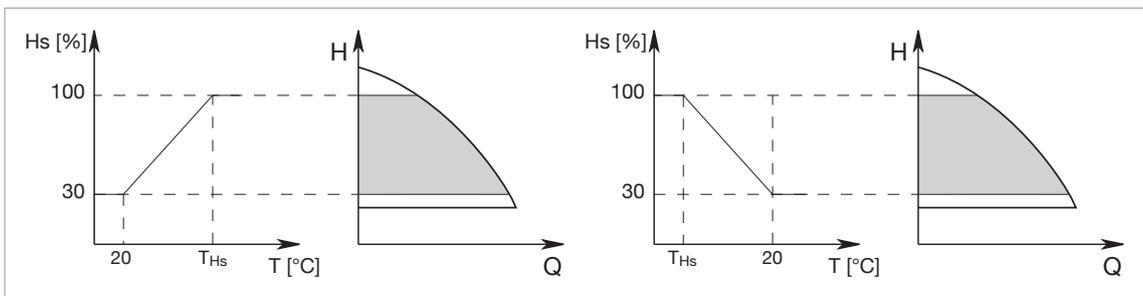
Il Setpoint relativo alla prevalenza del circolatore viene ridotto in funzione della temperatura dell'acqua. La temperatura del liquido può essere impostata da 0°C o a 100°C.
