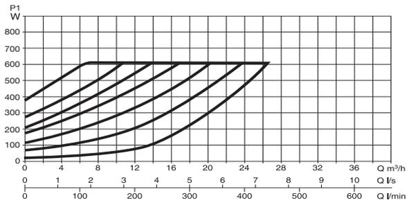
Le curve sono basate su valori di viscosità cinematica = 1 mm<sup>2</sup>/s e densità pari a 1000 kg/m<sup>3</sup>. Tolleranza delle curve secondo ISO9906. Curve a velocità fissa disponibili sul DNA.
