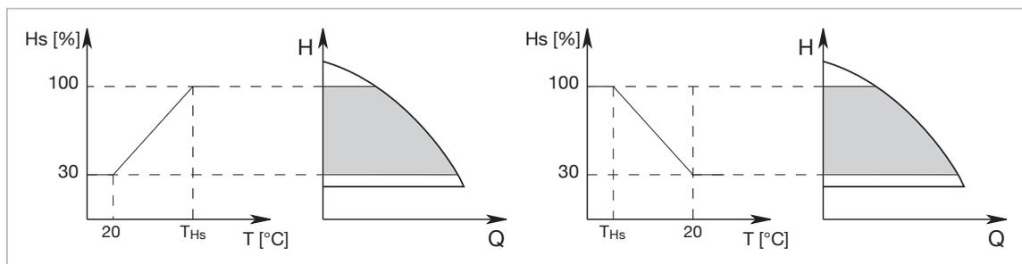
Il Setpoint relativo alla prevalenza del circolatore viene ridotto in funzione della temperatura dell'acqua. La temperatura del liquido può essere impostata da 0°C a 100°C.
