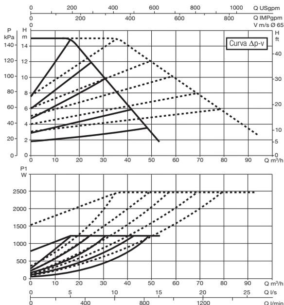
Le curve sono basate su valori di viscosità cinematica = 1 mm<sup>2</sup>/s e densità pari a 1000 kg/m<sup>3</sup>. Tolleranza delle curve secondo ISO9906. Curve a velocità fissa disponibili sul DNA.
