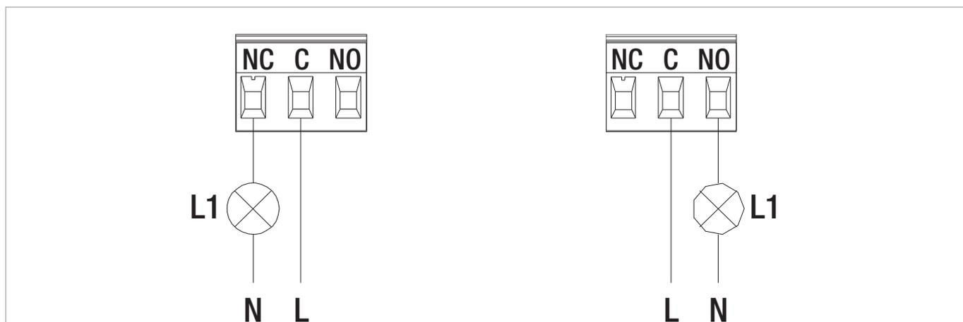
La funzione associata all'uscita OUT1 è "stato pompa" e la luce L1 si accende quando la pompa è in marcia e si spegne quando la pompa è ferma.
