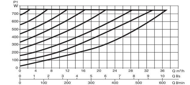
Le curve sono basate su valori di viscosità cinematica = 1 mm<sup>2</sup>/s e densità pari a 1000 kg/m<sup>3</sup>. Tolleranza delle curve secondo ISO9906. Curve a velocità fissa disponibili sul DNA.
