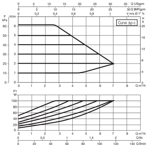
Le curve sono basate su valori di viscosità cinematica = 1 mm²/s e densità pari a 1000 kg/m³. Tolleranza delle curve secondo ISO9906. Curve a velocità fissa disponibili sul DNA.
