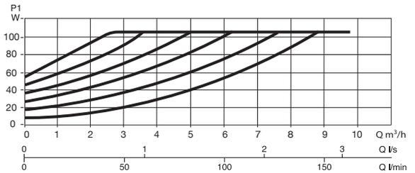
Le curve sono basate su valori di viscosità cinematica = 1 mm²/s e densità pari a 1000 kg/m³. Tolleranza delle curve secondo ISO9906. Curve a velocità fissa disponibili sul DNA.
