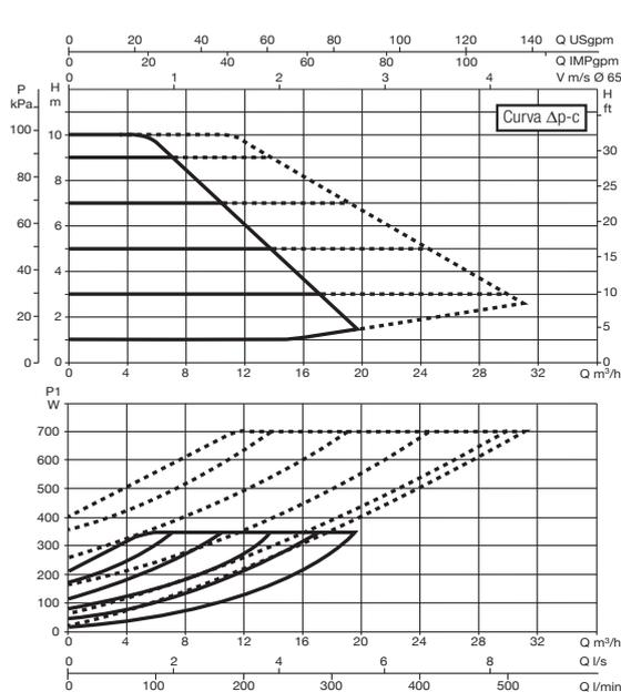
Le curve sono basate su valori di viscosità cinematica = 1 mm<sup>2</sup>/s e densità pari a 1000 kg/m<sup>3</sup>. Tolleranza delle curve secondo ISO9906. Curve a velocità fissa disponibili sul DNA.
