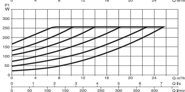
Le curve sono basate su valori di viscosità cinematica = 1 mm²/s e densità pari a 1000 kg/m³. Tolleranza delle curve secondo ISO9906. Curve a velocità fissa disponibili sul DNA.
