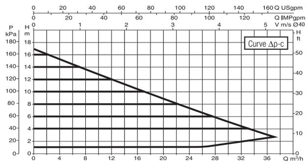
Le curve sono basate su valori di viscosità cinematica = 1 mm<sup>2</sup>/s e densità pari a 1000 kg/m<sup>3</sup>. Tolleranza delle curve secondo ISO9906. Curve a velocità fissa disponibili sul DNA.
