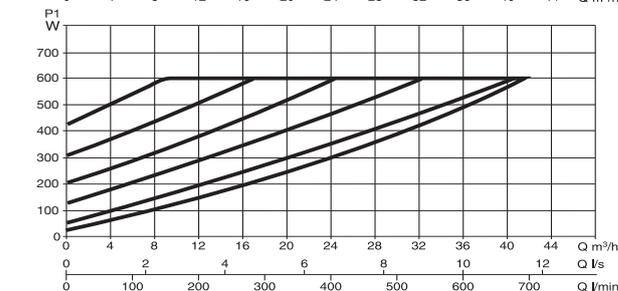
Le curve sono basate su valori di viscosità cinematica = 1 mm<sup>2</sup>/s e densità pari a 1000 kg/m<sup>3</sup>. Tolleranza delle curve secondo ISO9906. Curve a velocità fissa disponibili sul DNA.
