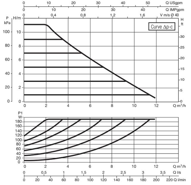
Le curve sono basate su valori di viscosità cinematica = 1 mm<sup>2</sup>/s e densità pari a 1000 kg/m<sup>3</sup>. Tolleranza delle curve secondo ISO9906. Curve a velocità fissa disponibili sul DNA.
