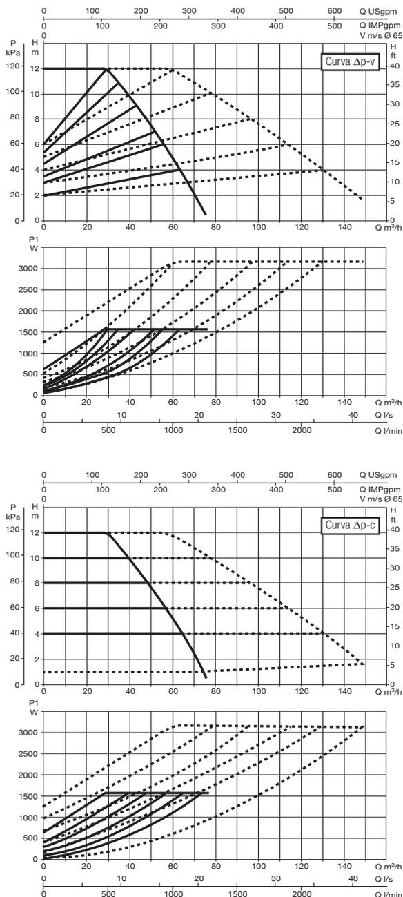
Le curve sono basate su valori di viscosità cinematica = 1 mm<sup>2</sup>/s e densità pari a 1000 kg/m<sup>3</sup>. Tolleranza delle curve secondo ISO9906. Curve a velocità fissa disponibili sul DNA.
