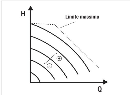
In questa modalità di regolazione il circolatore lavora su curve caratteristiche a velocità costante. La curva di funzionamento viene selezionata impostando la velocità di rotazione attraverso un fattore percentuale. Il valore 100% indica la curva limite massimo. La velocità di rotazione effettiva può dipendere dalle limitazioni di potenza e di pressione differenziale del proprio modello di circolatore. La velocità di rotazione può essere impostata da display o da segnale esterno 0-10V o PWM.
