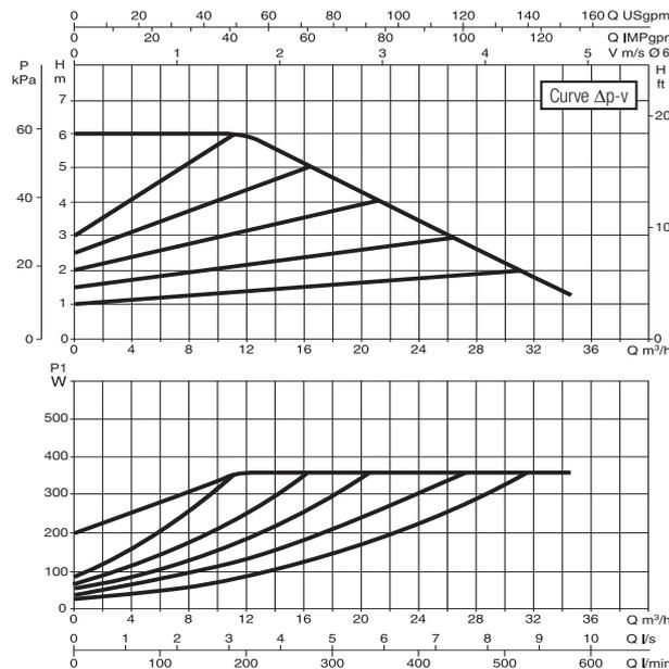
Le curve sono basate su valori di viscosità cinematica = 1 mm<sup>2</sup>/s e densità pari a 1000 kg/m<sup>3</sup>. Tolleranza delle curve secondo ISO9906. Curve a velocità fissa disponibili sul DNA.
