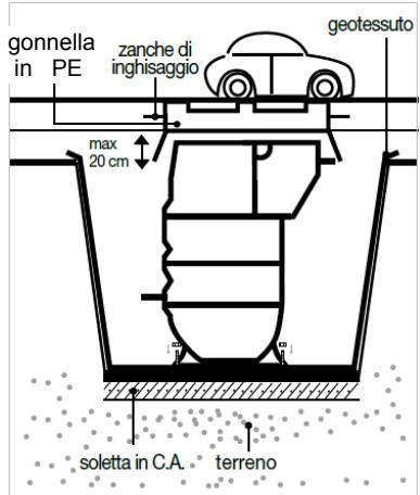
Per la carrabilità delle vasche di sollevamento tipo FEKAPOS MAXI è disponibile un accessorio di copertura superiore dotato di gonnella in polietilene (che permette la regolazione in altezza con un'escursione max di 20 cm) con chiusini carrabili montanti su telaio in acciaio dotato di zanche per l'inghisaggio alla platea in c.a. di copertura delle vasche.
