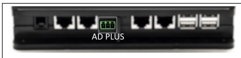
Рисунок 9А – Положение разъема в AD plus и в DConnect Box, пример подключения прямого кабеля can-bus к разъему DConnect Box для подсоединения AD plus
