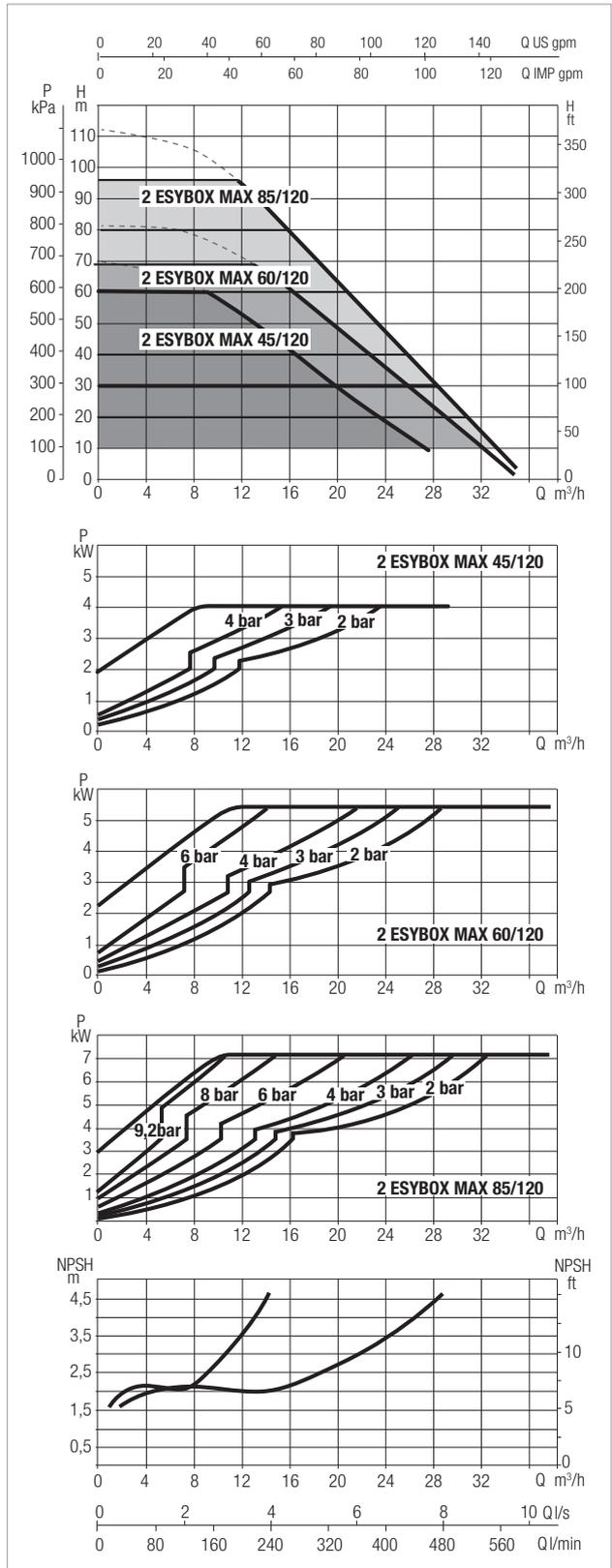
Le curve di prestazione sono basate su valori di viscosità cinematica = 1 mm²/s e densità pari a 1000 kg/m³. Tolleranza delle curve secondo ISO9906.
