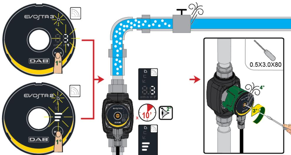
Рисунок 8: Удаление воздуха из насоса
