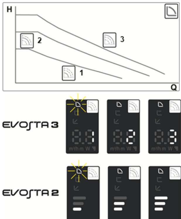
Bu ayarlama yönteminde sirkülatör sabit hızda karakteristik eğriler üzerinde çalışır.
