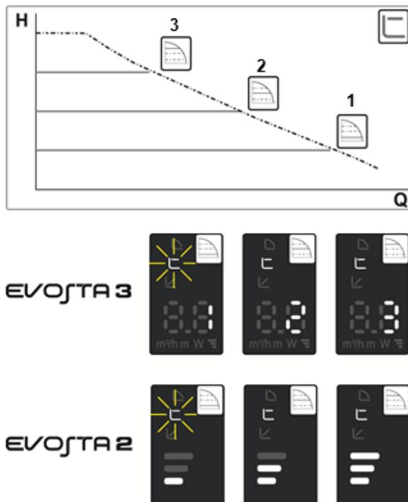
V tomto režimu je regulace diferenčního tlaku konstantní, nezávisle na požadavku vody. Set-point Hs může být nastavený na displeji.
