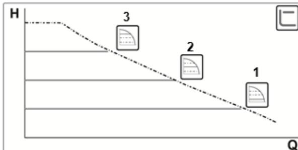
Bei diesem Regelungsmodus wird der Differentialdruck unabhängig vom Wasserbedarf konstant erhalten.
