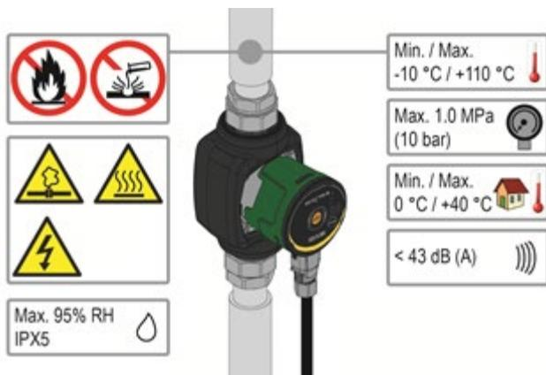
Εικόνα 1: Αντλούμενα υγρά, προειδοποιήσεις και συνθήκες λειτουργίας
