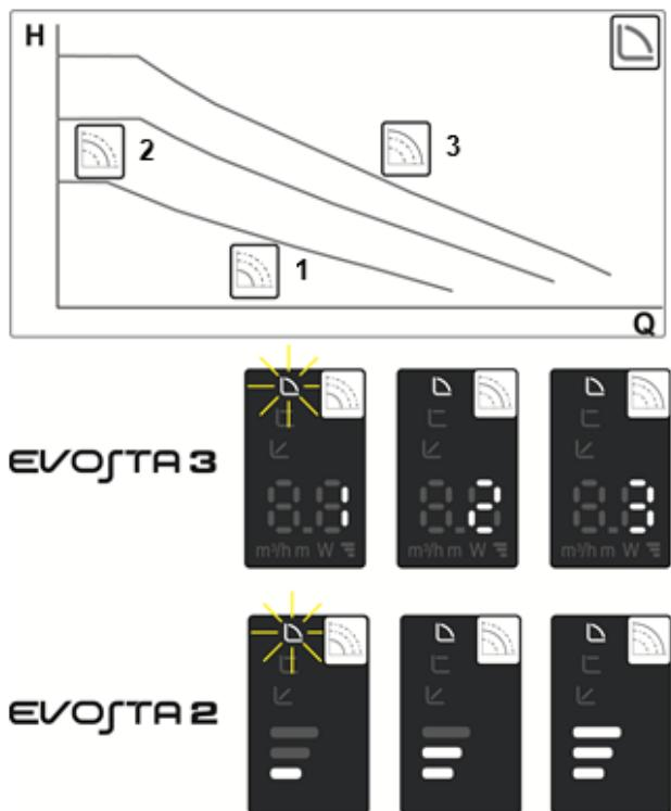
Avec ce mode de régulation, le circulateur travaille sur des courbes caractéristiques à vitesse constante.
