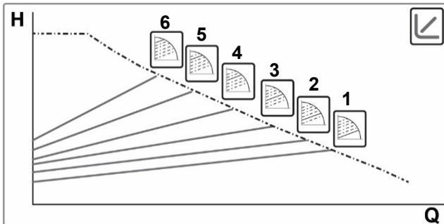
Тримаючи натисненою кнопку Mode протягом 20", виконується перехід до Просунутого Меню з можливістю вибору 6 кривих пропорційного диференційного тиску
