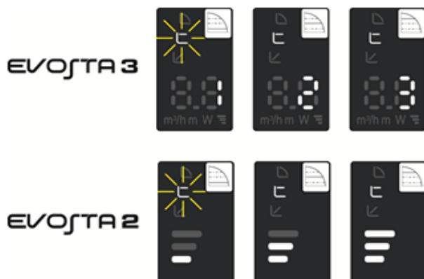
Ebben a beállítási módban a differenciálnyomás állandó marad, függetlenül a rendszer vízigényétől. A beállítási pont (Hs set-point) a display-n keresztül beállítható.
