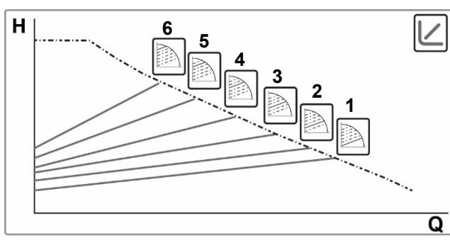
Door de toets Mode 20" in te drukken wordt het geavanceerde menu geopend; hier kan worden gekozen uit 6 curves van proportionele verschildruk
