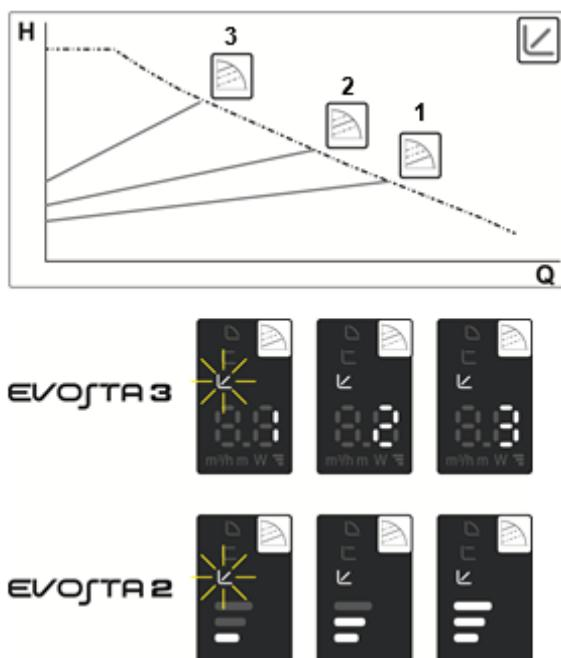
Ebben a működési módban a vízmennyiségi igény függvényében változik (csökken vagy nő) a differenciálnyomás. A beállítási pont ( $H_s$  set-point) a display-n keresztül beállítható. Ez a működési mód a következő esetekben javasolt:
