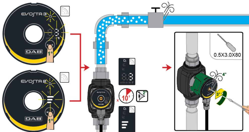
Figura 8: Drenagem da bomba
