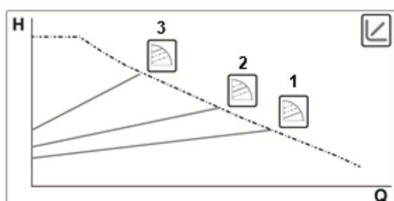
Avec ce mode de régulation, la pression différentielle est réduite ou augmentée suivant la diminution ou l'augmentation de la demande d'eau. Le point de consigne  $H_s$  peut être sélectionné à travers l'afficheur.
