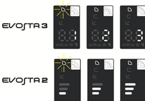
In acest mod de reglare circulatorul lucrează pe curbe caracteristice la viteză constantă.
