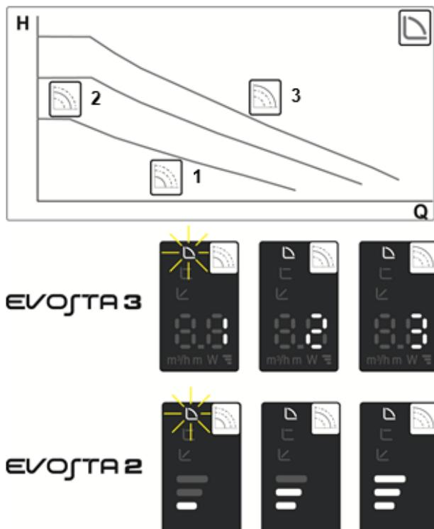
У цьому режимі регулювання циркуляційний насос працює по характерних кривих на постійній швидкості.
