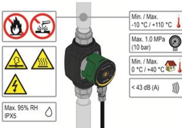
1. ábra: Szivattyúzott folyadékok, figyelmeztetések és működési feltételek
