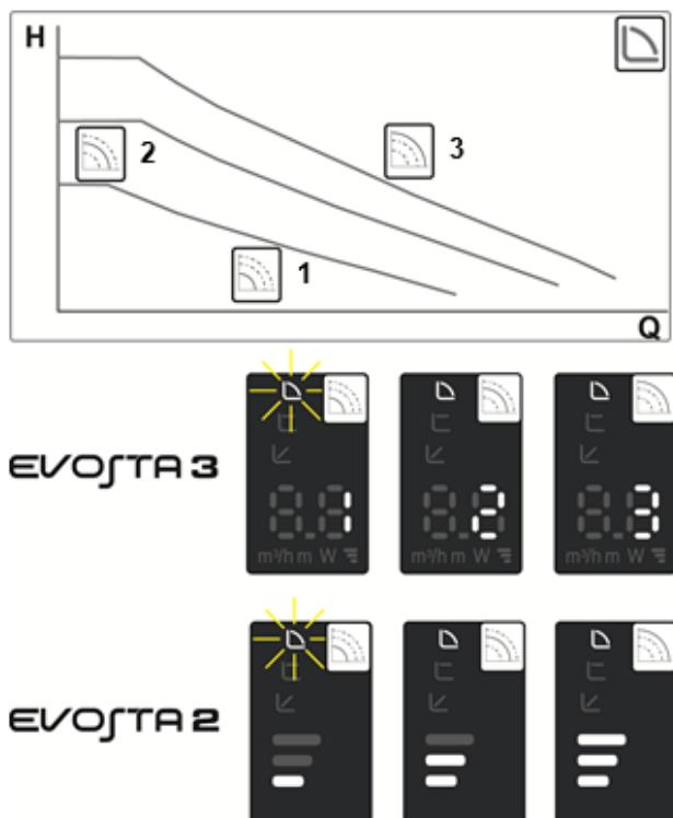
Za tohoto způsobu regulačního cirkulační čerpadlo pracuje po charakteristických křivkách s konstantní rychlostí.
