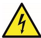
Pirms darbu veikšanas iekārtas elektriskajā vai mehāniskajā daļā, vienmēr atvienojiet to no elektrības tīkla. Uzgaidiet, kad vadības panelī izslēgsies gaismas indikatori pirms ierīces atvēršanas. Starpkontūra līdzstrāvas kondensators saglabā lādiņu ar bīstami lielu spriegumu arī pēc elektrības tīkla atvienošanas.
