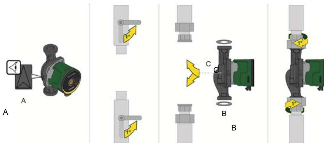
Figura 2: Montaje de una bomba EVOSTA2, EVOSTA3
