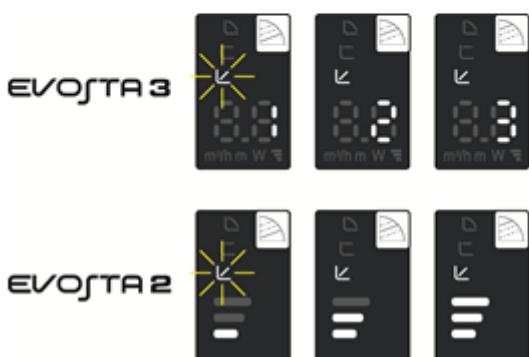
V tomto regulačním režimu se diferenční tlak snižuje nebo zvyšuje podle snížení nebo zvýšení požadavku vody.
