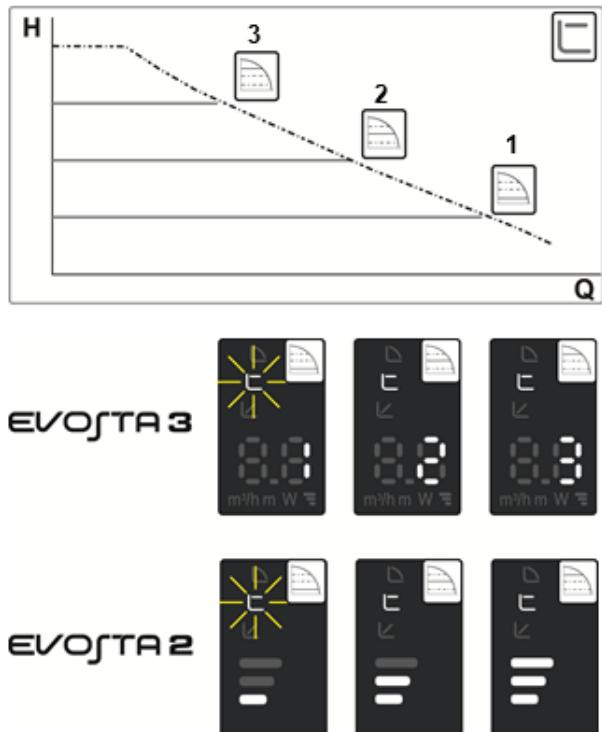
Bu ayarlama yönteminde diferansiyel basınç, su talebinde bağımsız olarak sabit tutulur.
