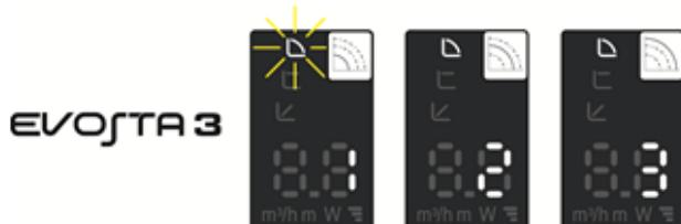
I denne reguleringssmåde arbejder cirkulationspumpen på karakteristiske kurver med konstant hastighed.
