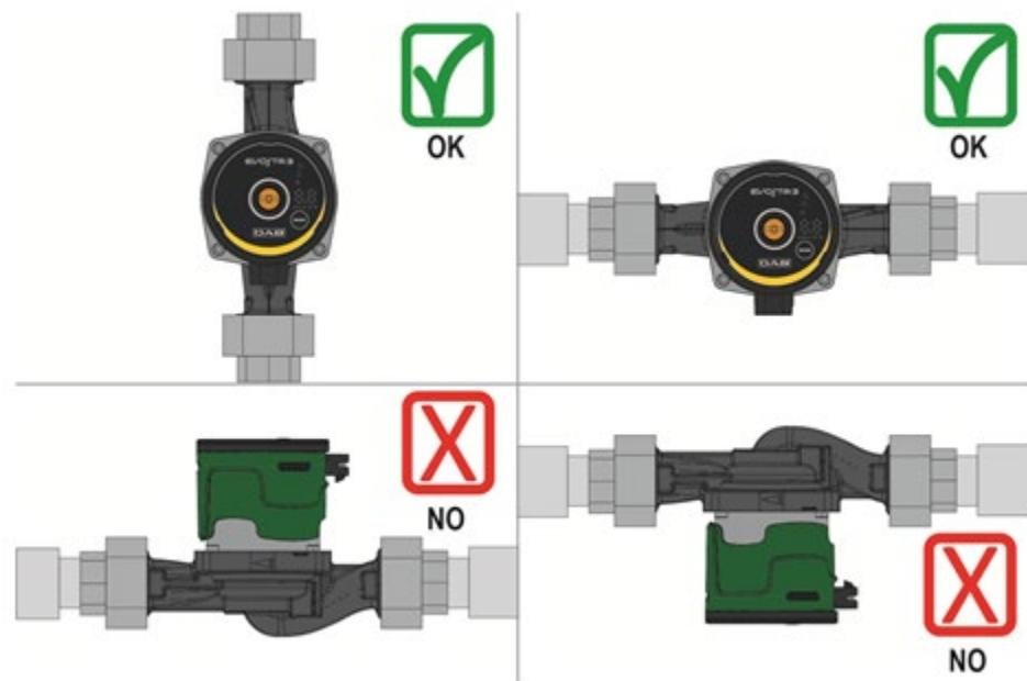
Рисунок 3: Монтажное положение
