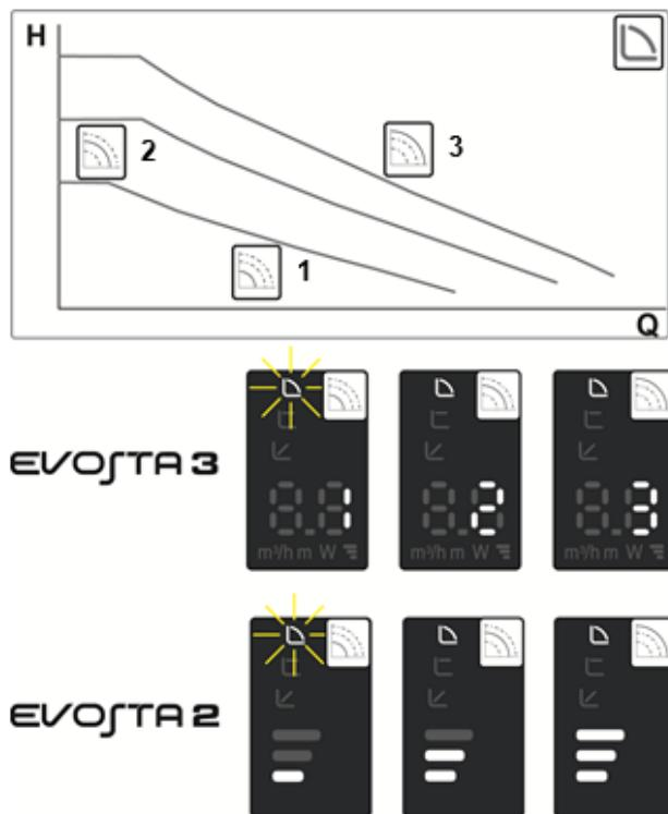
В этом режиме регуляции циркуляционный насос работает по типичным кривым с постоянной скоростью.
