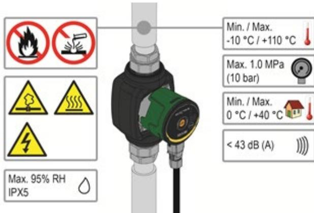
Figura 1: Líquidos bombeados, avisos e condições de funcionamento
