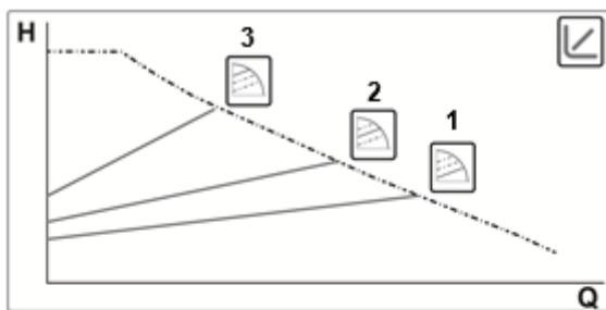
Bei diesem Regelungsmodus wird der Differentialdruck je nach verringertem oder erhöhtem Wasserbedarf gesenkt oder erhöht. Der Sollwert  $H_s$  kann über das externe Display eingestellt werden.
