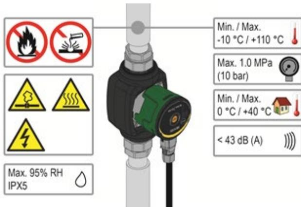
Image 1: Liquides pompés, avertissements et conditions de fonctionnement
