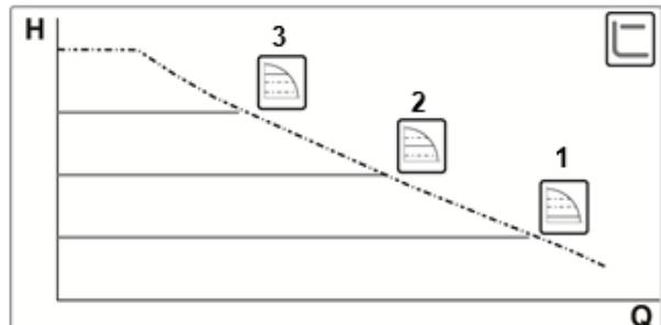
Avec ce mode de régulation, la pression différentielle est maintenue constante, indépendamment de la demande d'eau.
