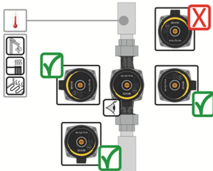
Fig 4: Användargränssnittets positioner
