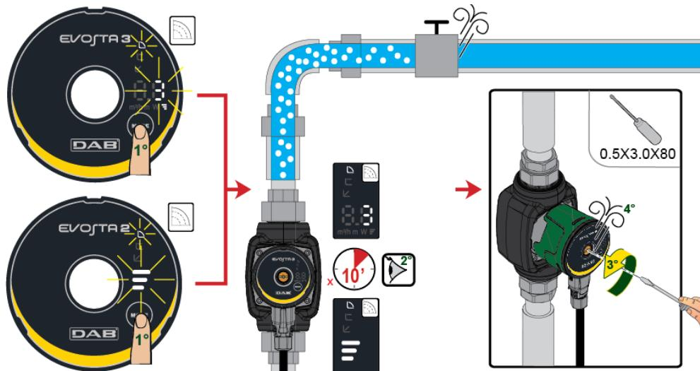
Obrázek 8: Odvzdušnění čerpadla
