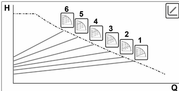
Натискайки бутона Mode в продължение на 20 секунди се получава достъп до Разширеното Меню при възможност за избор между 6 криви с пропорционално диференциално налягане
