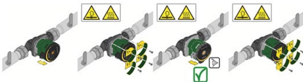
Figura 6: Troca de posição da interface utilizador
