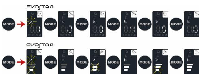
Нажатие кнопки Mode в течение 20" открывает доступ в Расширенное меню, где можно выбрать одну из 6 характеристик регулирования по пропорциональному дифференциальному давлению
