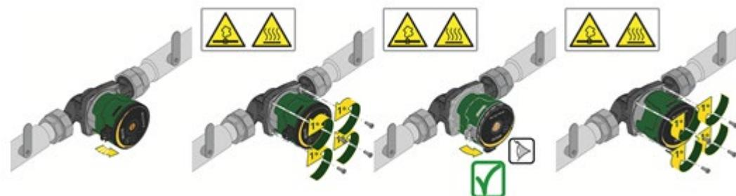
Afbeelding 6: Verandering van de positie van de gebruikersinterface
