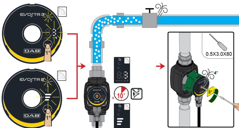
Obrázok 8: Odvzdušnenie čerpadla
