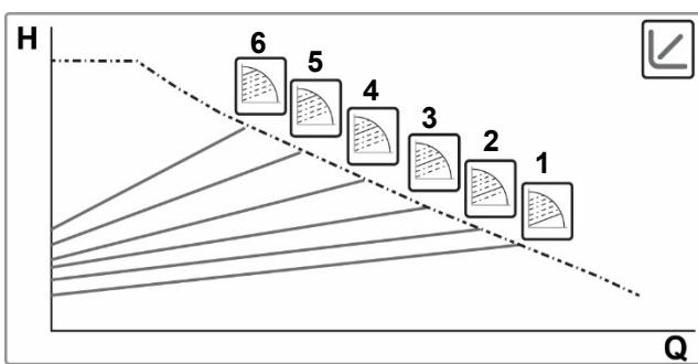
Podržením stisknutého tlačítka Mode na 20" získáte přístup k Pokročilému menu s možností volby z 6 křivek proporcionálního diferenčního tlaku.
