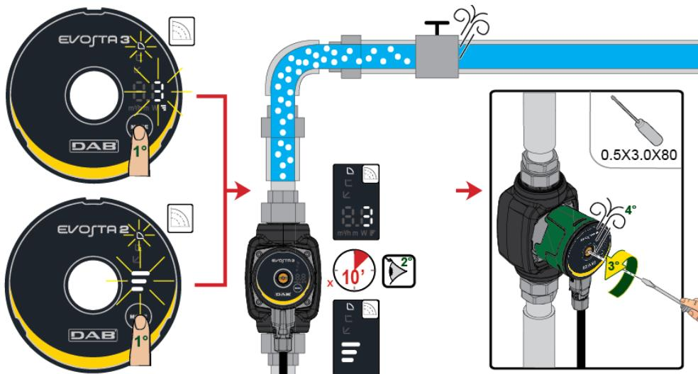
Abb 8: Pumpenentlüftung
