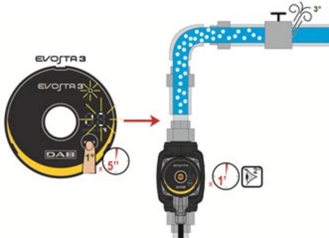
Abb. 9: Automatische Pumpenentlüftung
