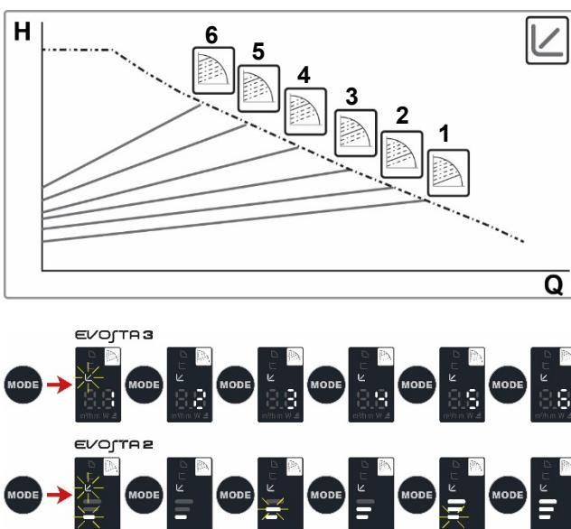
Hold tasten Mode trykket nede i 20 sekunder for at få adgang til den avancerede menu med mulighed for at vælge mellem 6 kurver med proportionalt differenstryk.
