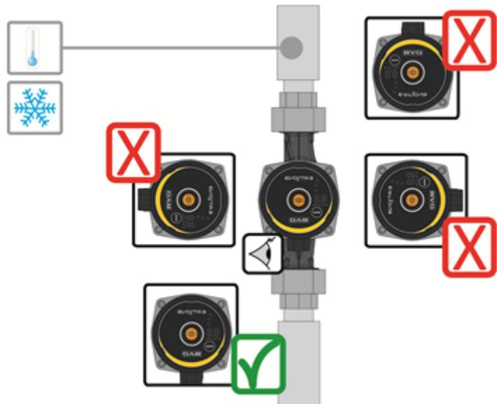
Fig 5: Användargränssnittets positioner
