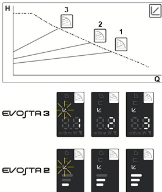
In deze regelmodus wordt het drukverschil verkleind of vergroot naarmate de vraag om water af- of toeneemt.
