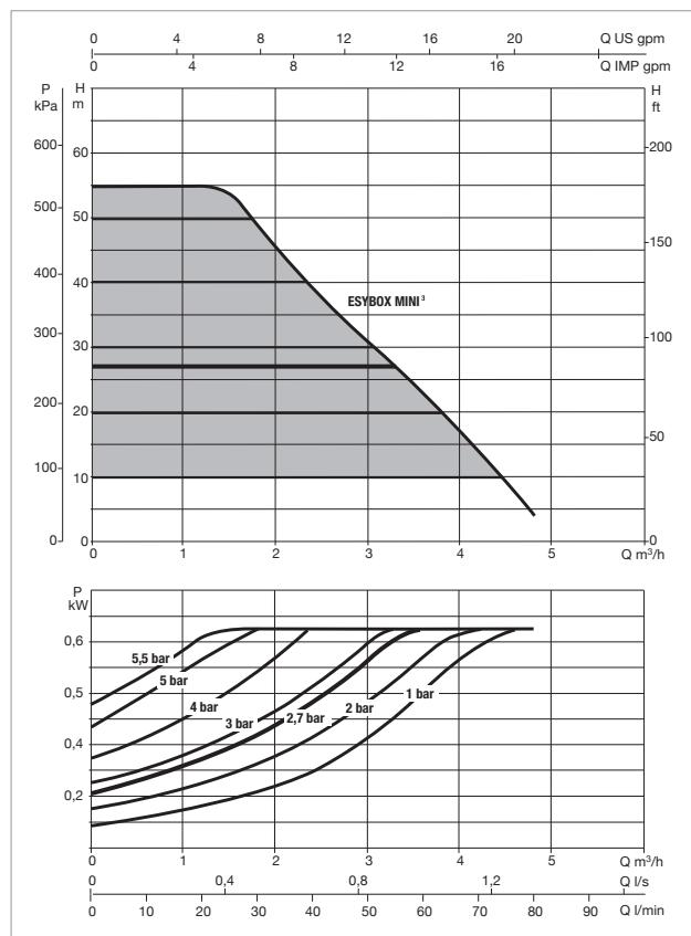
Le curve di prestazione sono basate su valori di viscosità cinematica = 1 mm<sup>2</sup>/s e densità pari a 1000 kg/m<sup>3</sup>. Tolleranza delle curve secondo ISO9906.
