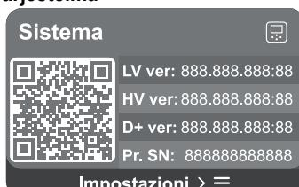
Sivun oikealla puolella ovat parametrit, joissa ilmoitetaan invertteri ja sen laiteohjelmaversiot, ja vasemmalla puolella QR-koodi, joka sisältää suurimman osan tuotteen tunnistustiedoista.
