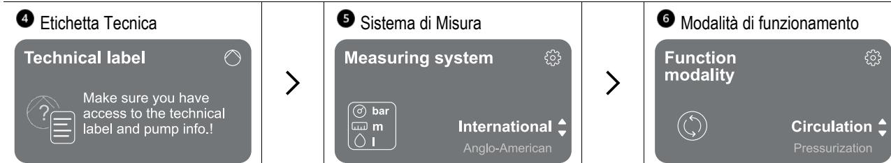
L'ultimo passo della configurazione iniziale prevede la scelta della modalità di funzionamento: Pressurizzazione o Circolazione. Proseguire poi con la creazione di gruppi multi-pompa.
