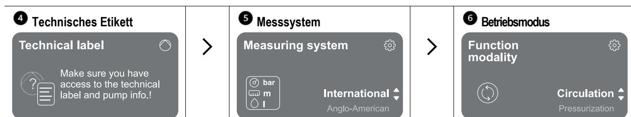
Der letzte Schritt der Erstkonfiguration betrifft die Wahl des Betriebsmodus: Druckerhöhung oder Umwälzung. Dann die Mehrpumpengruppen erstellen.
