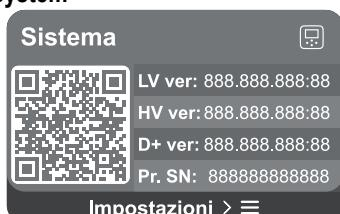
Na ekranie po prawej stronie wyświetlane są parametry identyfikujące tablicę i jej wersje oprogramowania sprzętowego, a po lewej stronie kod QR zawierający więcej danych identyfikacyjnych produktu.
