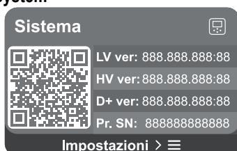
V pravé části obrazovky jsou zobrazeny identifikační parametry měniče a jeho verzí firmwaru, zatímco vlevo je uveden QR kód obsahující většinu identifikačních údajů výrobku.
