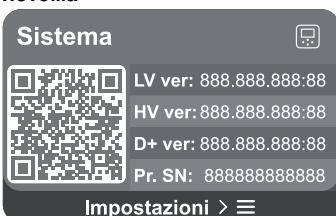
На экране справа отображаются параметры, идентифицирующие панель и версию программно-аппаратного обеспечения, а слева — QR-код, содержащий дополнительные идентификационные данные устройства.
