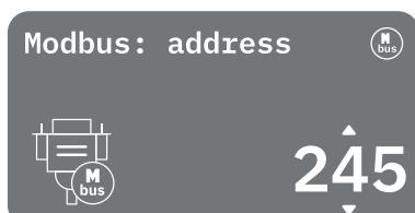
Протокол реализован в устройстве, на входе RS 485.
