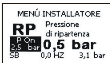
Figure 19: Configuration de la pression de redémarrage
