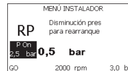
Figura 17: Configuración de la presión de reencendido
