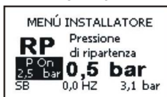
Figura 11: Configuración de la presión por re arranque
