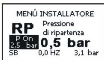
Abbildung 11: Einstellung des Neustartdrucks
