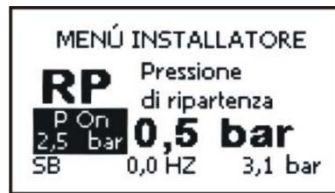
Şekil 11: Yeniden başlatma basıncının ayarlanması
