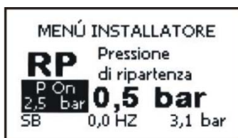
Рисунок 11: Настройка давления нового включения
