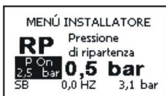
Σχήμα 11: Ρύθμιση της πίεσης επανεκκίνησης
