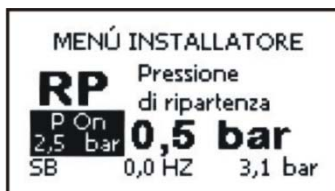
Малюнок 11: Налаштування тиску нового увімкнення
