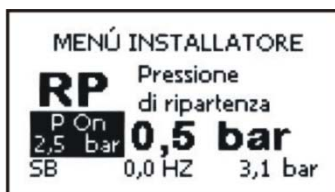
Rysunek 11: Ustawianie wartości ciśnienia uruchamiania
