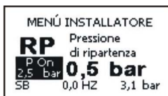
Figure 11: Configuration de la pression de redémarrage
