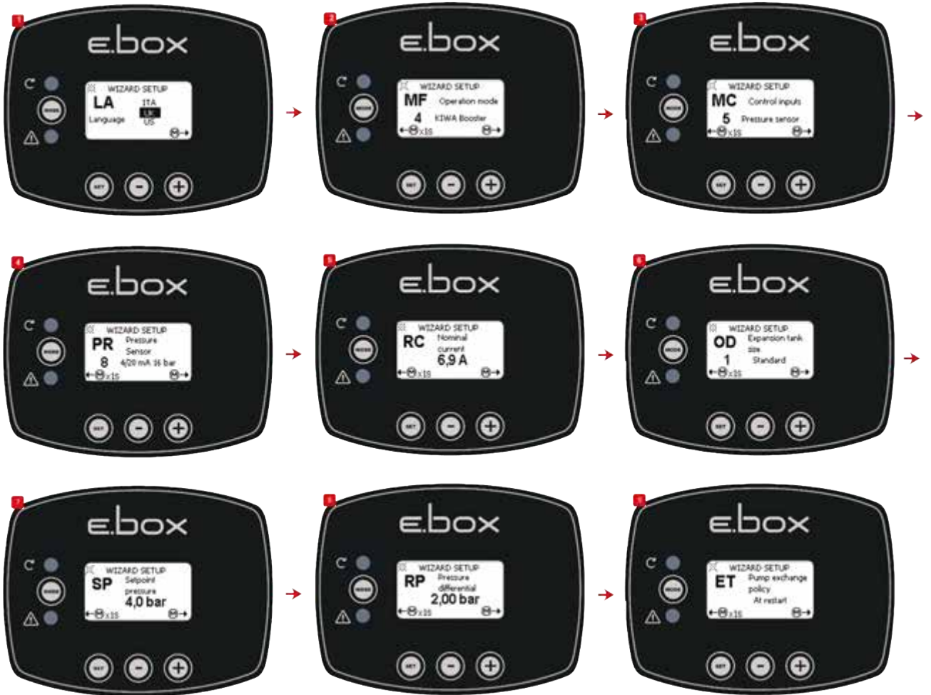
الشكل 48: ضغط KIWA باستخدام مستشعر الضغط
