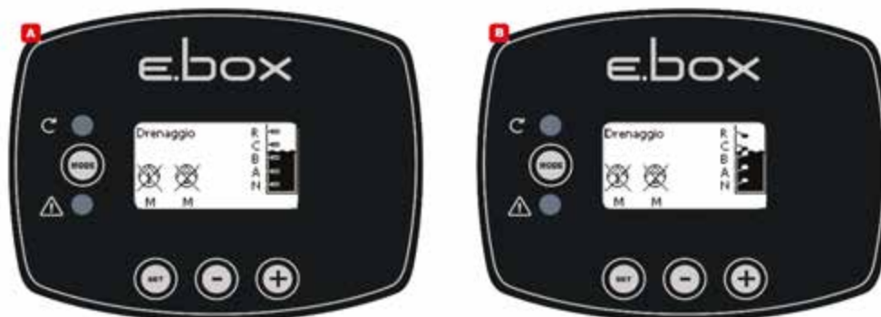
Afbeelding 37: Status van het systeem in de ontwateringsmodus A met niveauvoelers. B met vlotters
