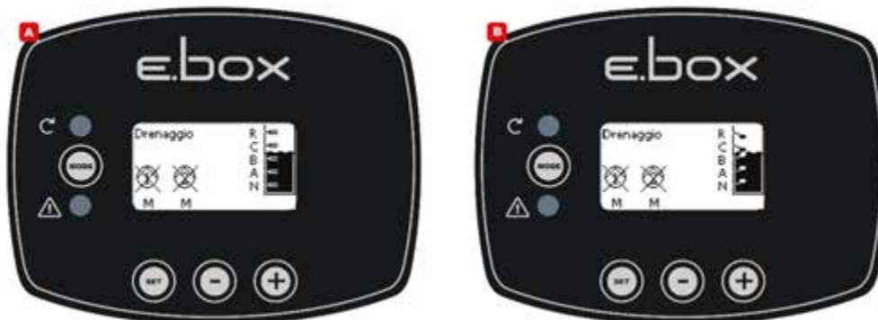
Kuva 37. Järjestelmän tila tyhjennyksessä, A tasoantureilla, B uimureilla
