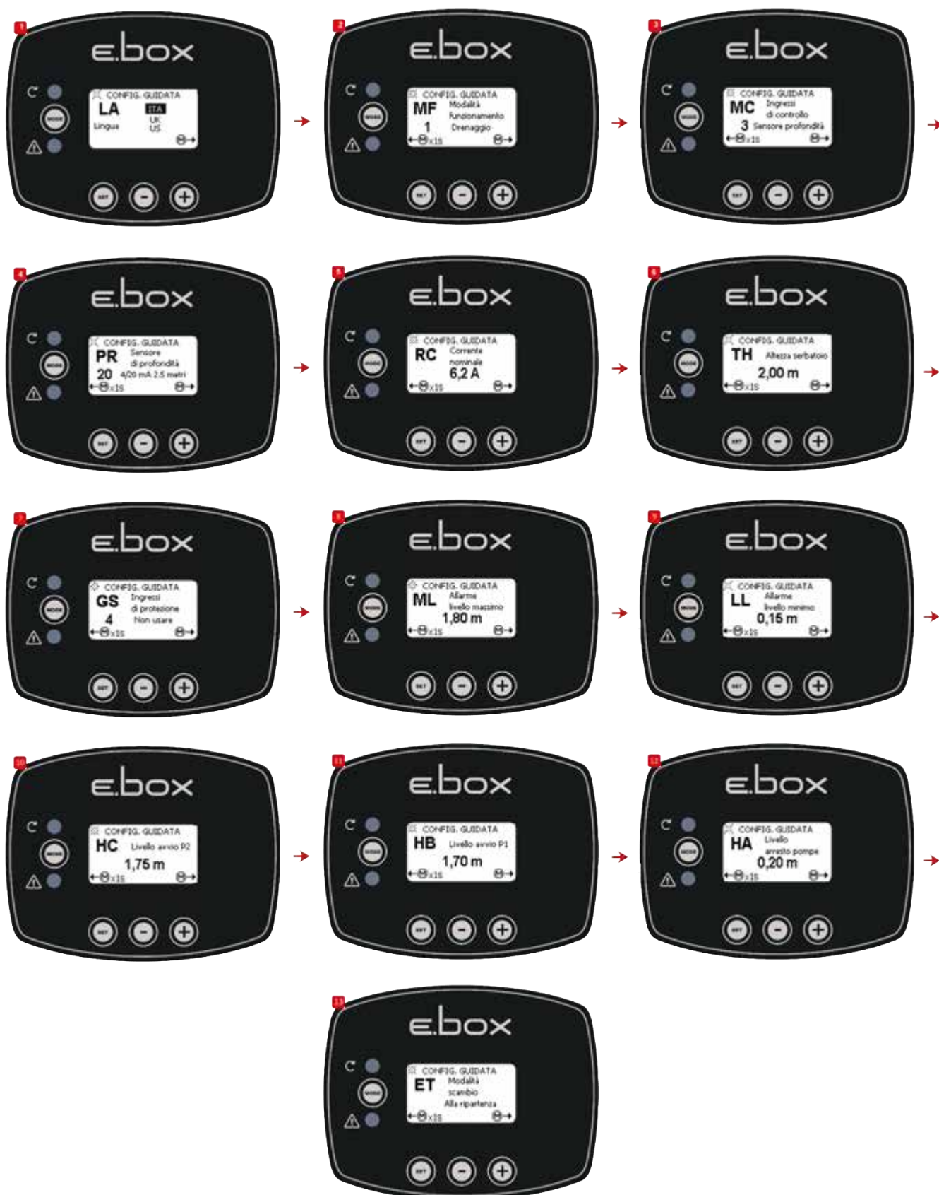
Схема 38: Конфігурація тільки з датчиком глибини
