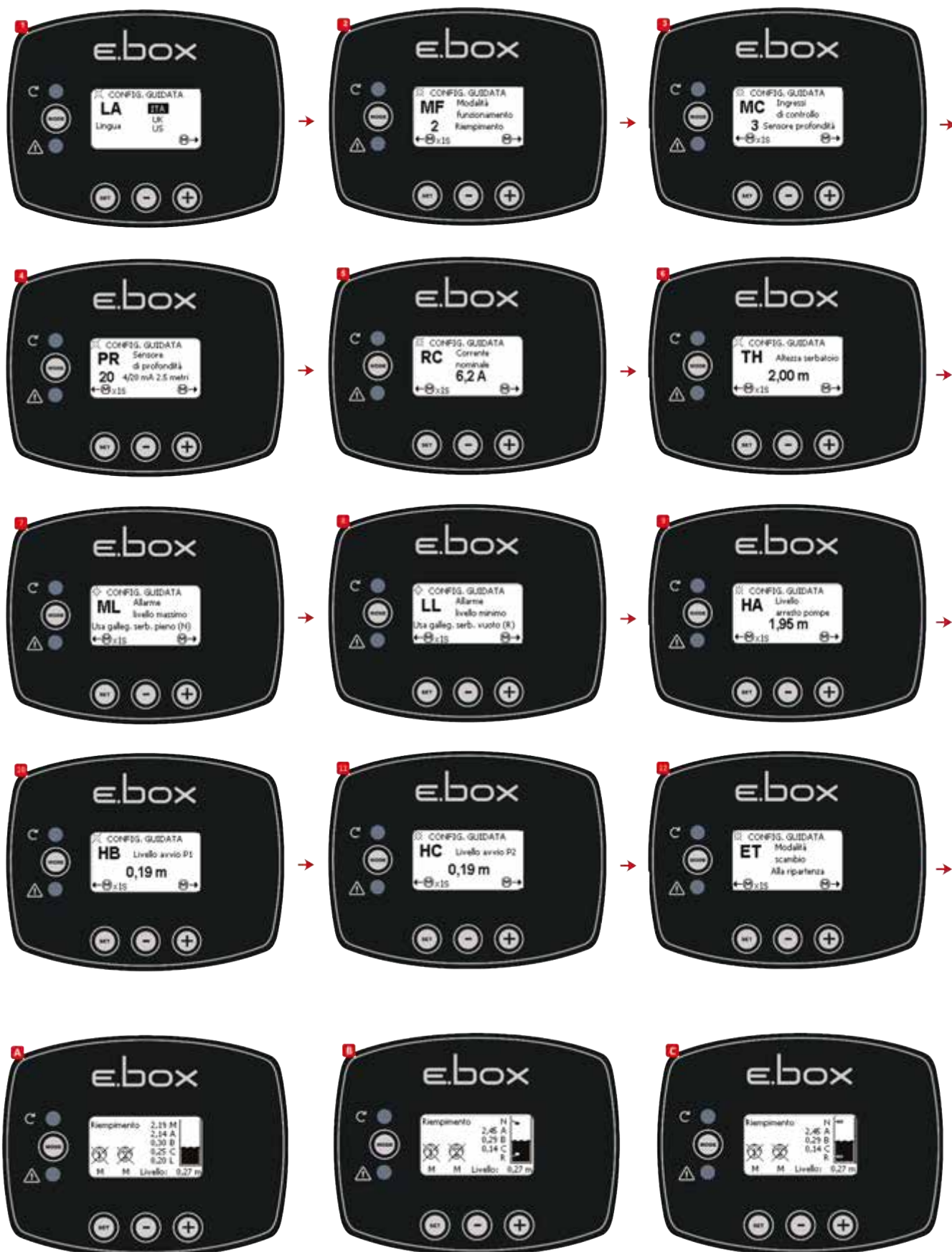
Obrázek 26: A Stav systému pouze s hloubkovým čidlem, B hloubkové čidlo a plováky, C hloubkové čidlo a hladinová čidla
