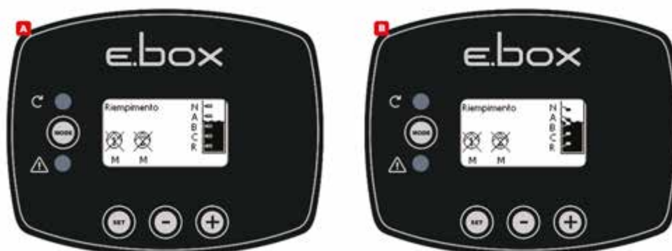
Kuva 25. Järjestelmän tila täytössä, kun ohjaustuloina ovat uimurit tai tasoanturit
