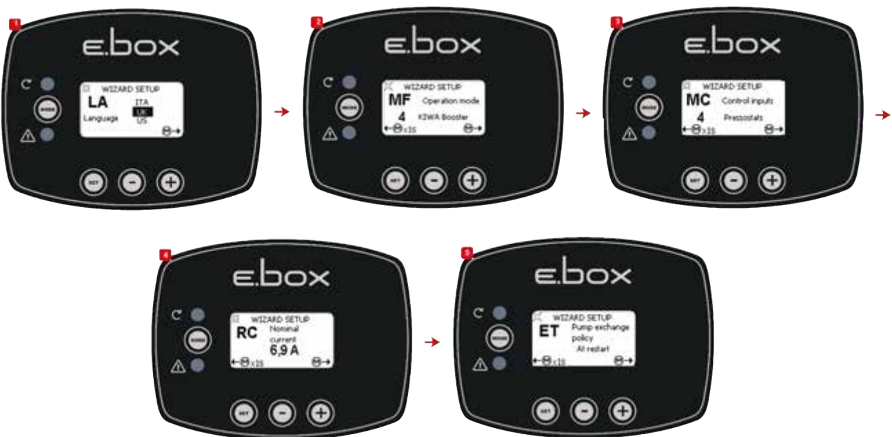
Figure 49 : Configuration KIWA avec des pressostats
