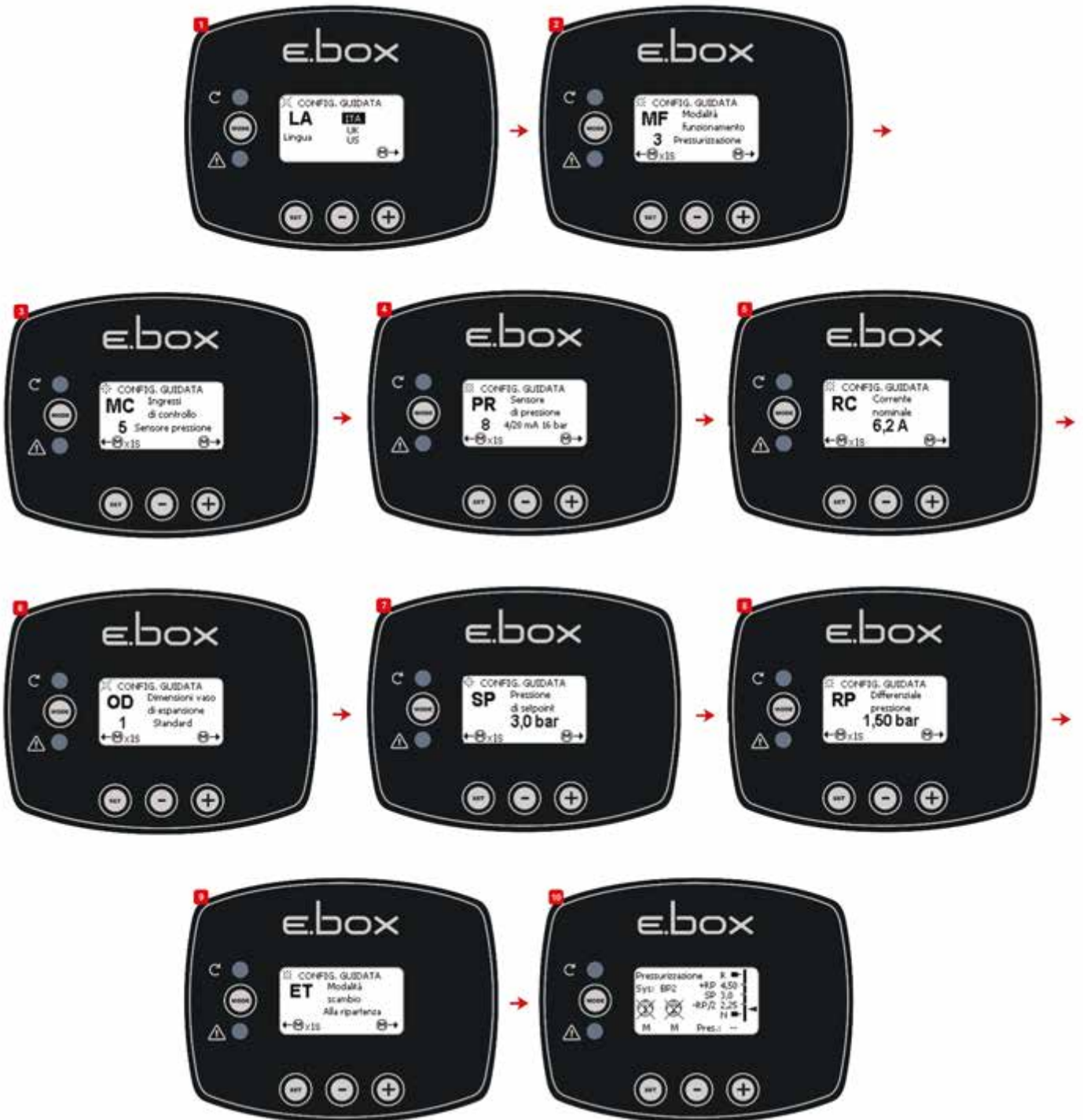
Схема 12: Конфигурация с датчиком давления
