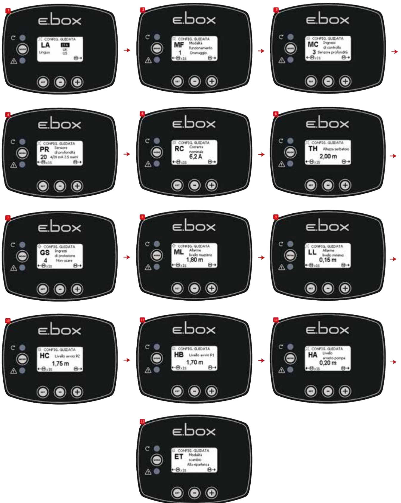
Abbildung 38: Konfiguration mit nur dem Tiefensensor
