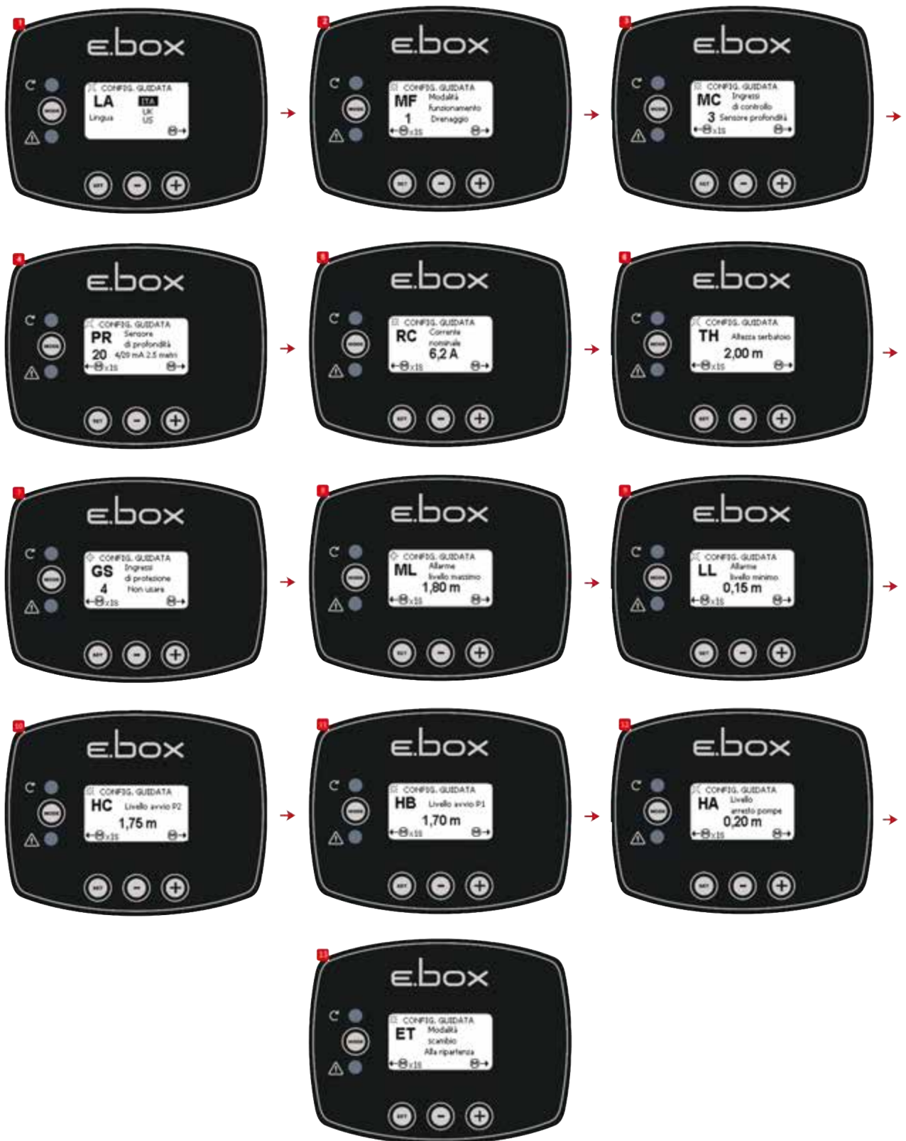
Figura 38: Configurazione con solo sensore di profondità
