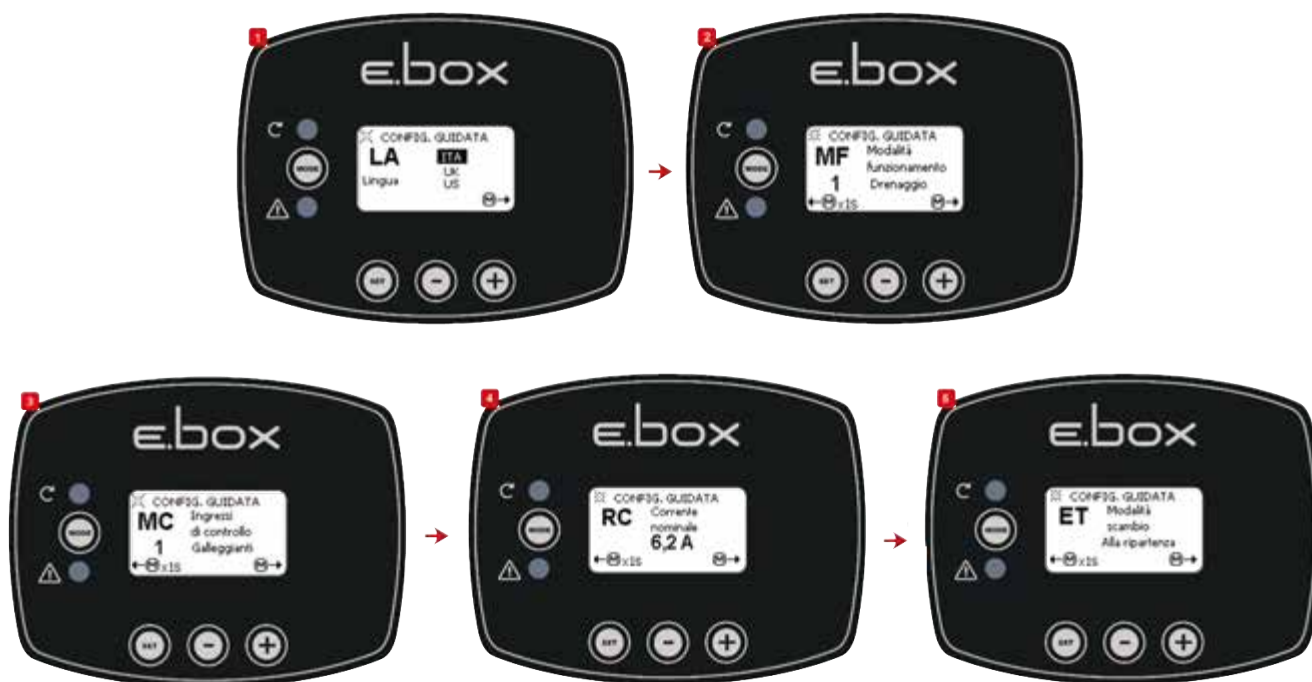
Figura 36: Configurație Drenaj plutitori sau sonde de nivel
