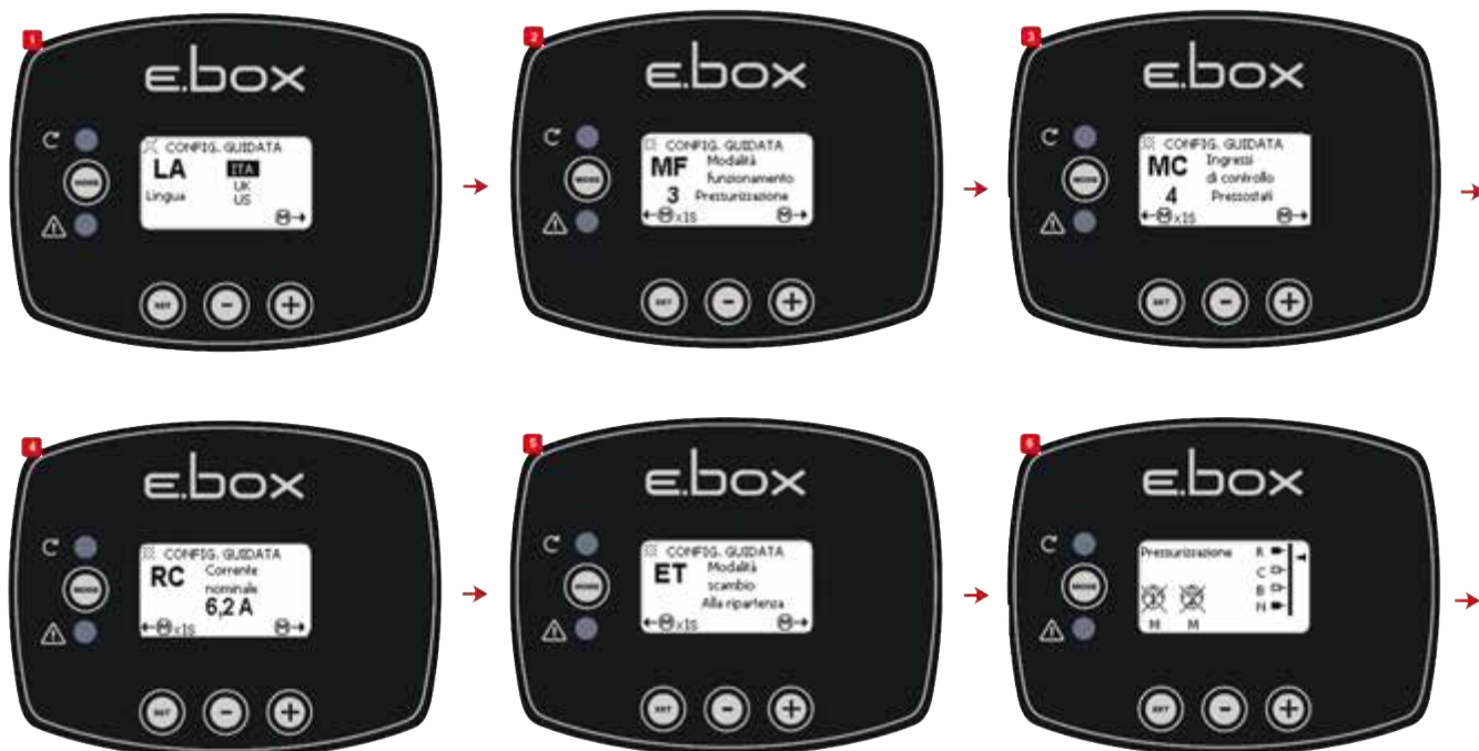
Εικόνα 13: Διαμόρφωση με Πιεσοστάτες
