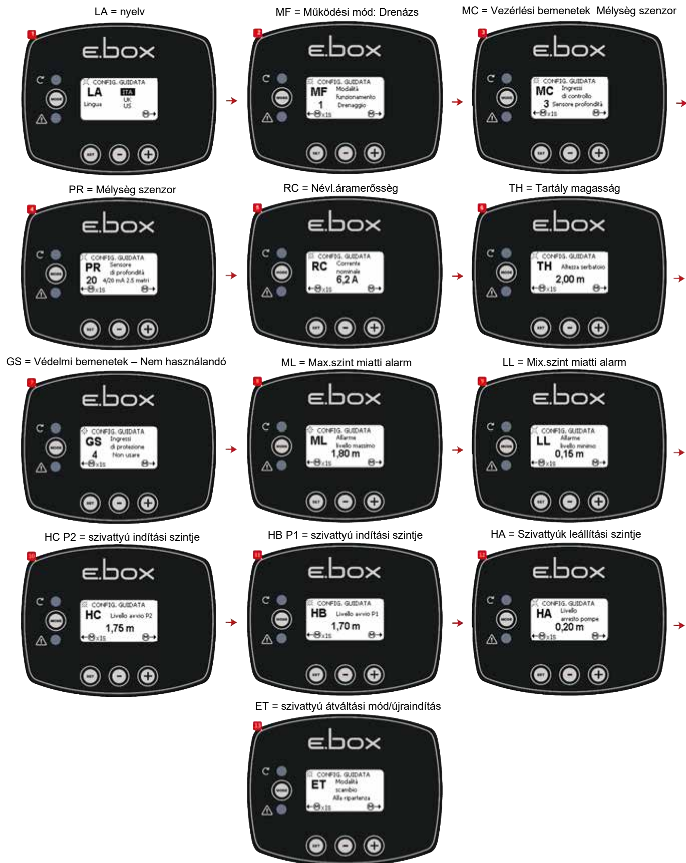
38.ábra: Konfiguráció egyetlen mélység szenzorral
