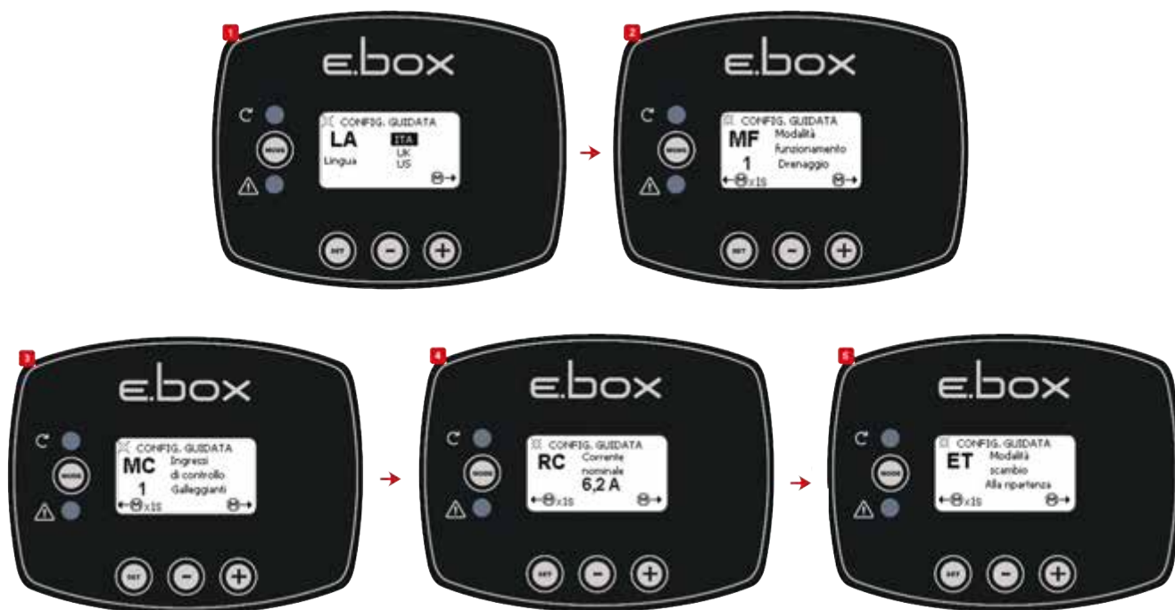
Rysunek 36: Konfiguracja pływaków lub sond poziomu Drenaggio
