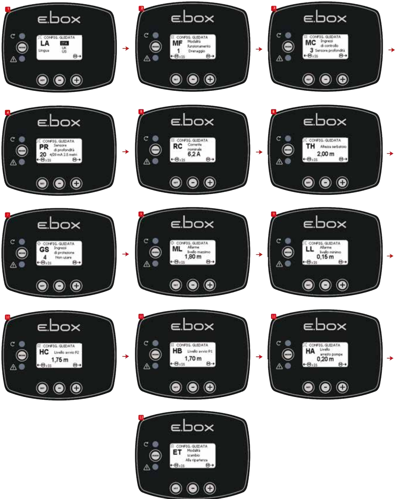
الشكل 38: التهيئة باستخدام مستشعر العمق فقط
