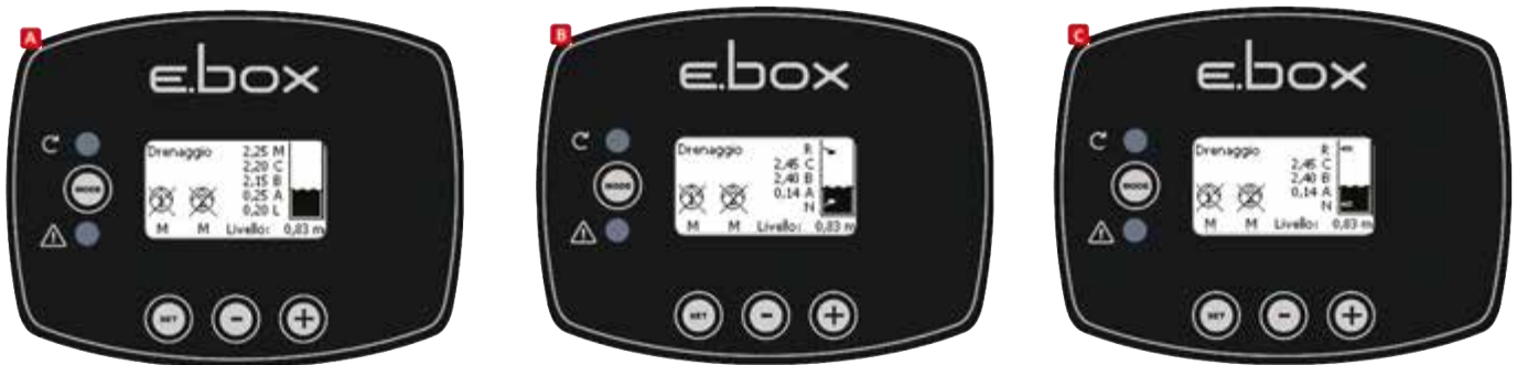
Figura 39: Estado del sistema en las configuraciones. A - sólo con sensor de profundidad, B - sensor de profundidad y flotadores, C - sensor de profundidad y sondas de nivel
