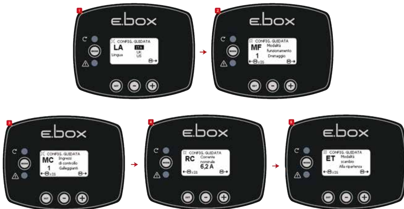
Εικόνα 36: Διαμόρφωση πλωτήρων ή αισθητηρίων στάθμης στην αποστράγγιση
