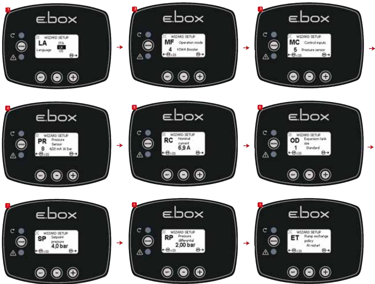
Εικόνα 48: Δημιουργία πίεσης KIWA με αισθητήρα πίεσης
