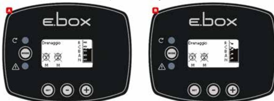
Figura 37: Stato del sistema in modalità drenaggio, A con sonde di livello. B con galleggianti
