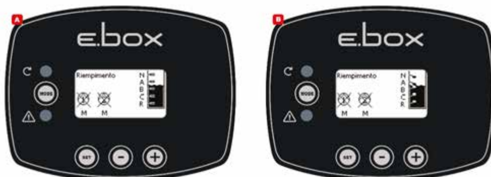
Схема 25: Стан системи в режимі наповнення з контрольними введеннями поплавців або датчиків рівня
