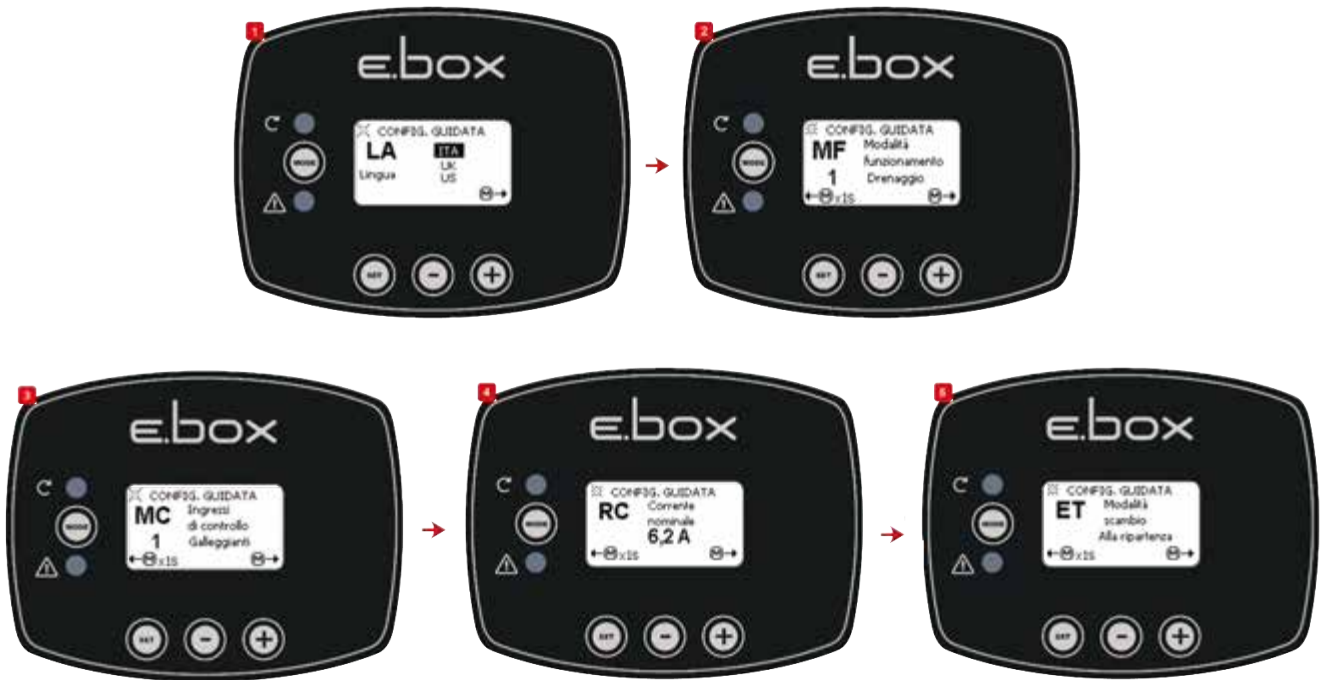
Схема 36: Конфигурация Дренажа поплавков или зондов уровня
