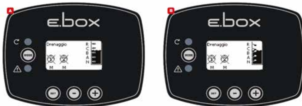
Схема 37: Состояние системы в режиме дренажа А с зондами уровня. В с поплавками
