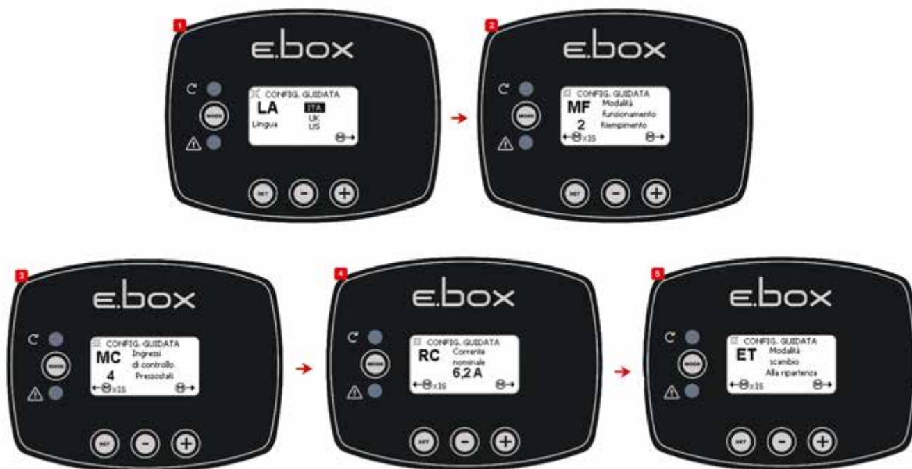
Obrázek 24: Nastavení plnění pomocí plováků nebo hladinových čidel
