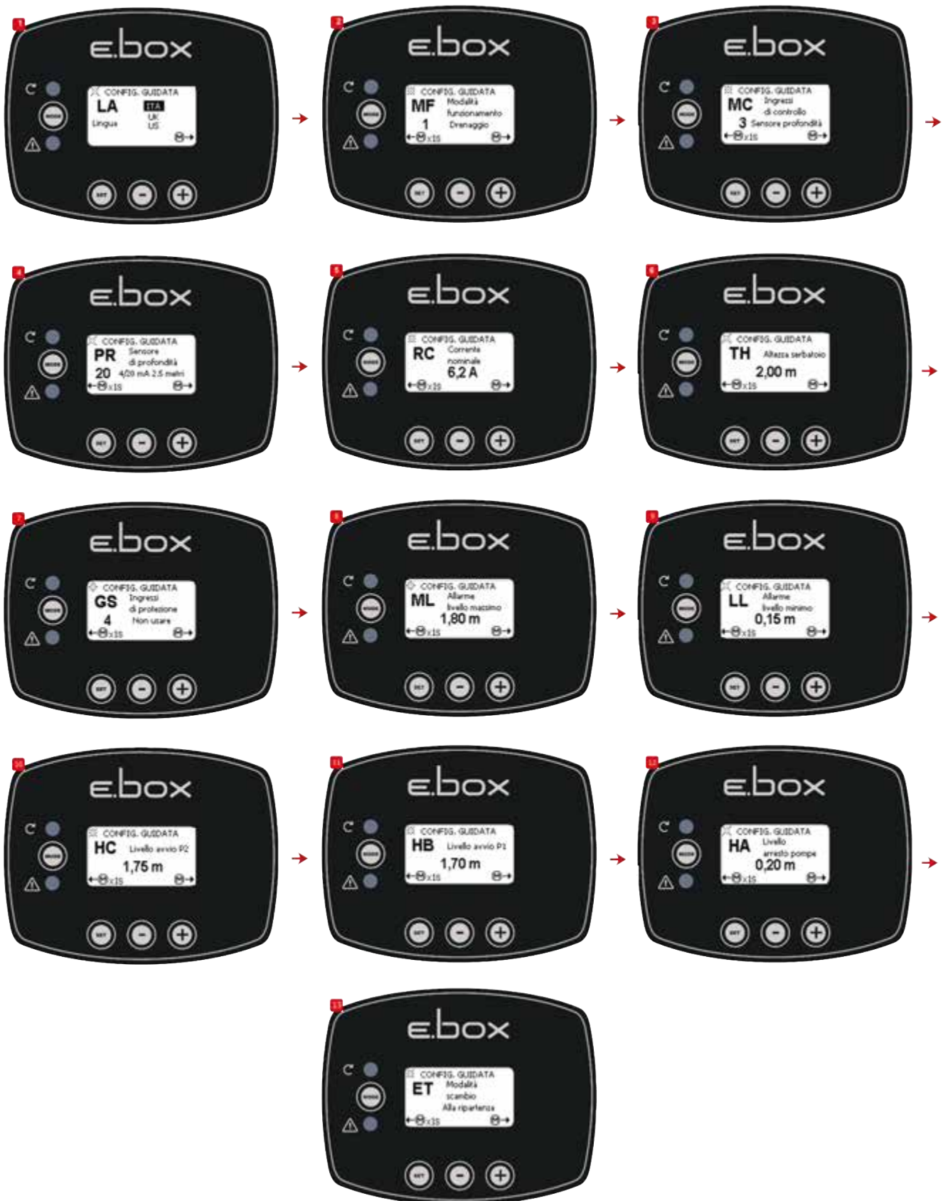
Figura 38: Configuración sólo con sensor de profundidad
