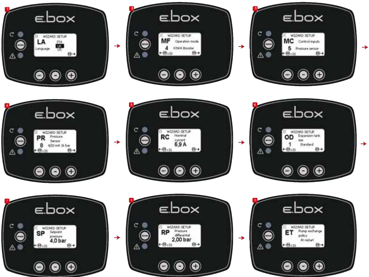
Figure 48 : Pressurisation KIWA avec capteur de pression
