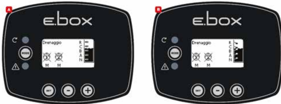
الشكل 37: حالة النظام في وضع التصريف، A مع مجسات المستوى، B مع المُبادلات الكهربائية العائمة
