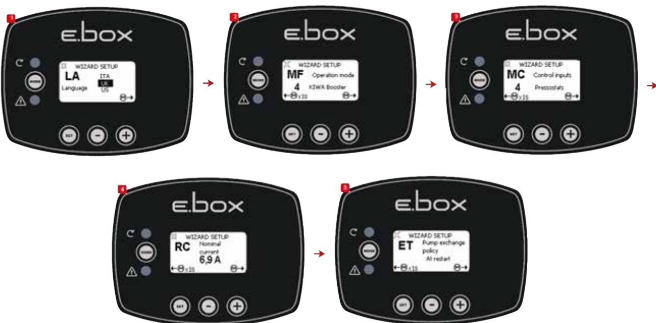
Figura 49: Configuración Kiwa con presostatos
