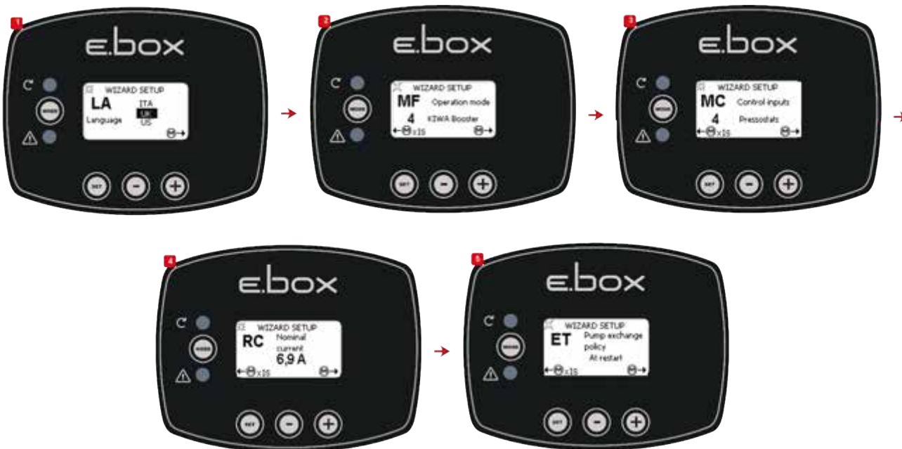
Схема 49: Конфигурация KIWA с реле давления
