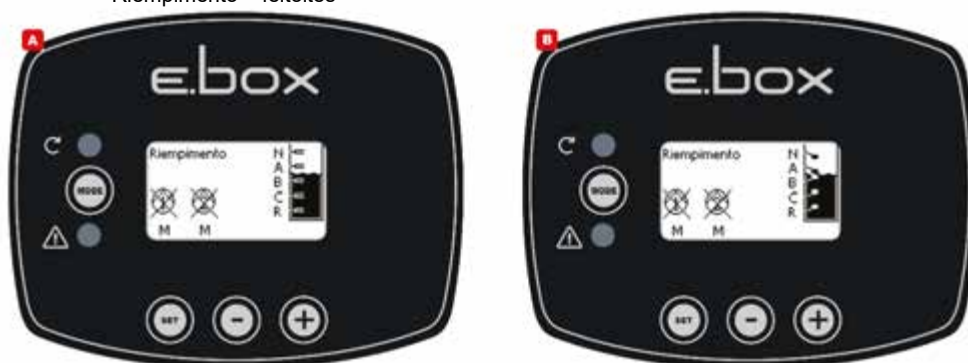
25.ábra: A rendszer státusza feltöltési módban úszókapcsolós vagy szintszenzoros bemenetekkel
