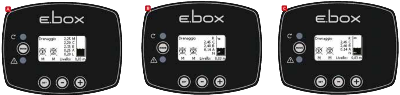
Figura 39: Starea sistemului în configurații A doar cu senzor de profunzime, B: senzor de profunzime și plutitori, C senzor de profunzime și sonde de nivel
