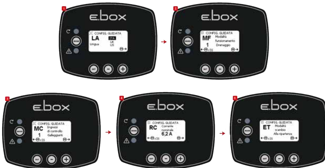
Figura 36: Configurazione Drenaggio galleggianti o sonde di livello
