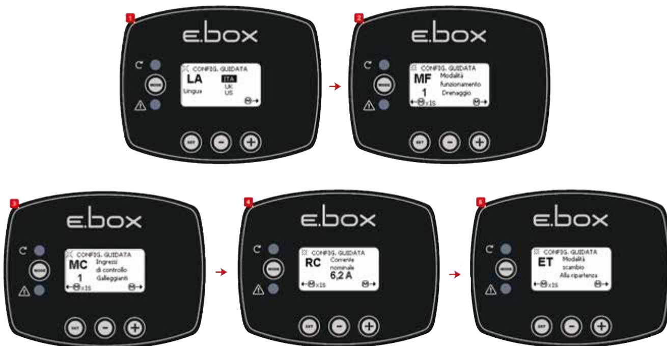
Afbeelding 36: Configuratie Ontwatering met vlotters of niveauvoelers
