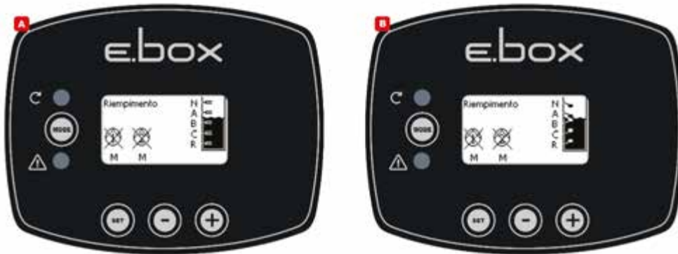
الشكل 25: حالة النظام في وضع التعبئة، مع مداخل التحكم في المُبادلات الكهربائية العامة أو مجسات المستوى
