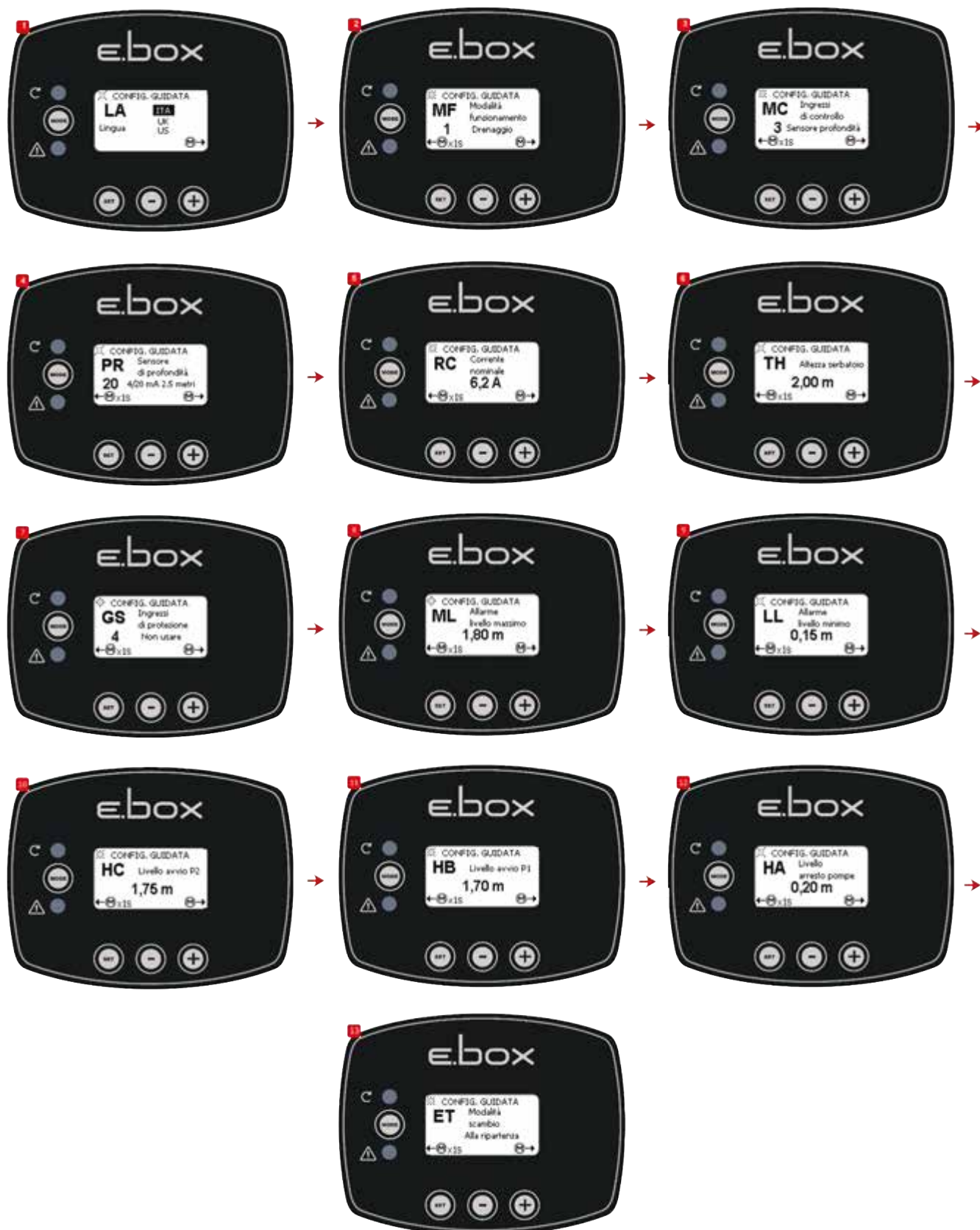
Obrázek 38: Nastavení pouze s hloubkovým čidlem
