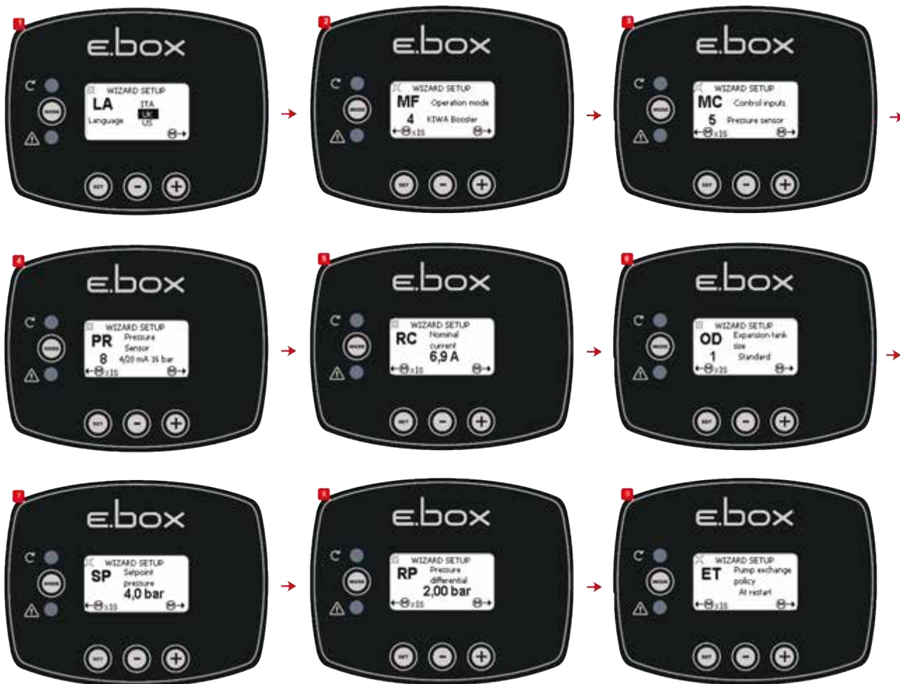
Схема 48: Подпор KIWA с датчиком давления
