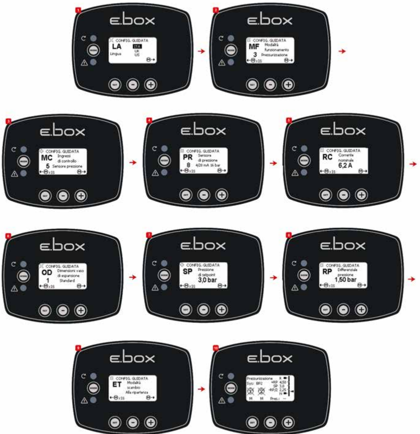
Afbeelding 12: Configuratie met druksensor
