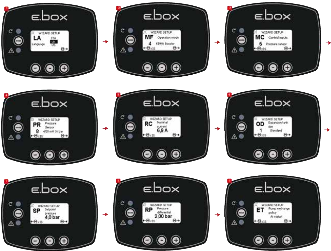
Figura 48: Presurización KIWA con sensor de presión
