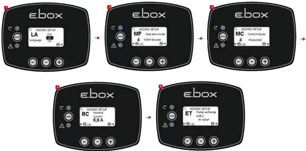
Afbeelding 49: Configuratie met Kiwa-drukschakelaars
